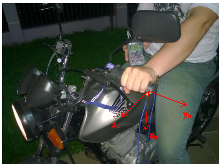
Figura 4.3 – Acelerômetro posicionado no guidom para procedimento de medição.
