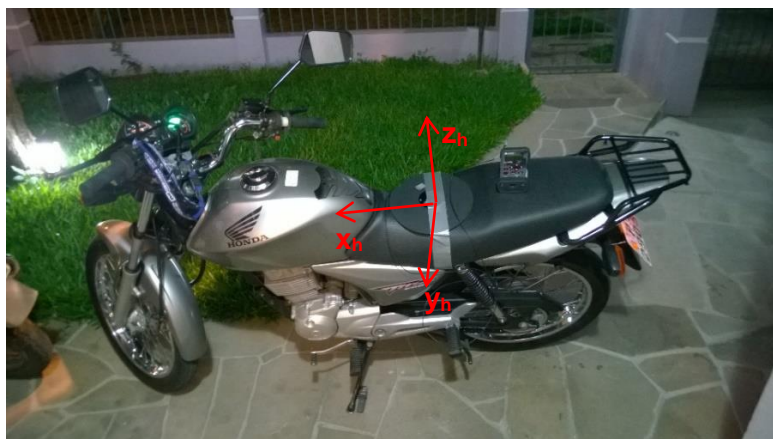
Figura 4.2 – Seatpad posicionado corretamente no assento para procedimento de medição.
