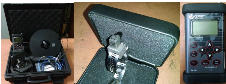
Figura 4.1 – Kit equipamentos VI400-Pro e transdutores utilizados nas medições.
