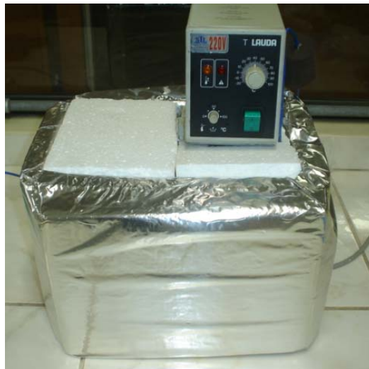
Figura 6.8: Fotografia do banho de medição com isolamento térmico.
