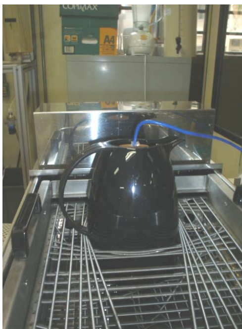
Figura 7.1: Fotografia do calorímetro de mistura disposto no 'shaker'.
