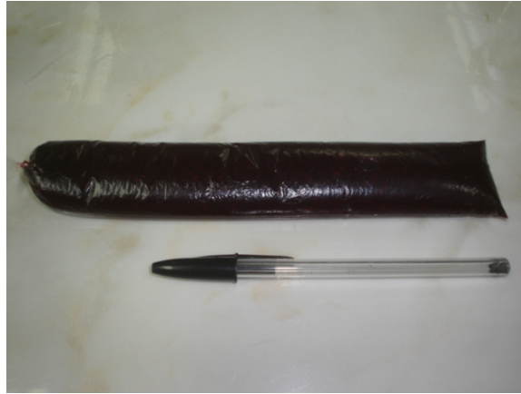
Figura 7.2: Fotografia do acondicionamento das amostras de polpa em pequenos sacos de PEBD, para a determinação do calor específico.
