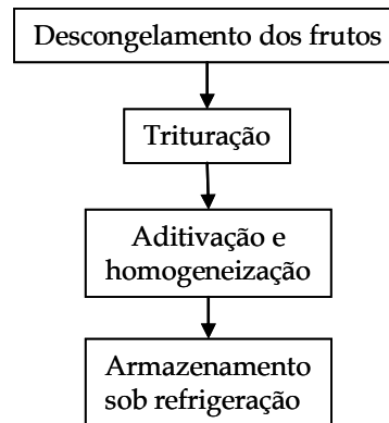
Figura 3.3: Fluxograma do processamento das polpas em escala de bancada.
