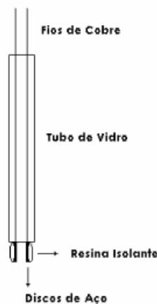
Figura 5.1: Desenho esquemático da sonda para medição da condutividade elétrica.
