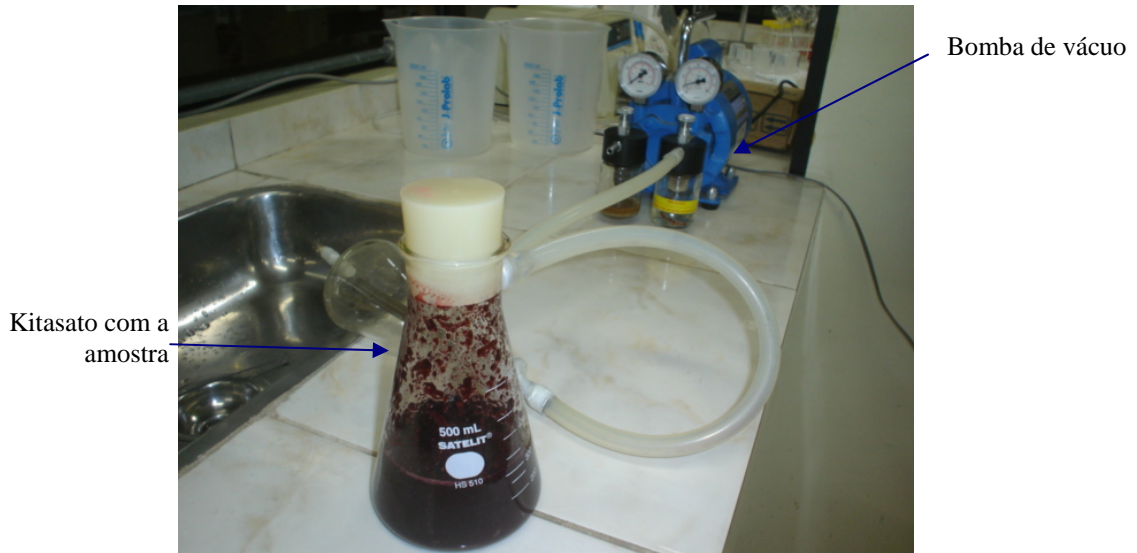
Figura 3.4: Fotografia do sistema para desaeração das polpas.
