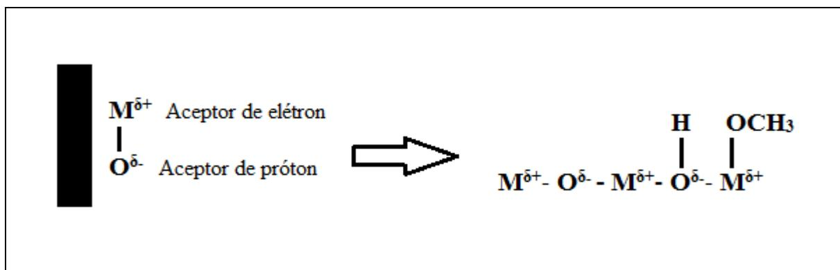
**Figura 5:** Estrutura superficial de óxidos metálicos.
