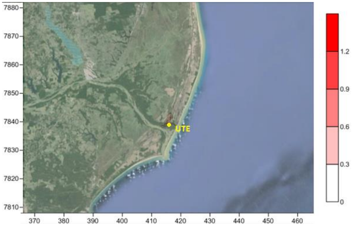
Figura A.4 - Concentração média de SO 2 em 90 h de simulação (µg/m 3 ), com coordenadas geográficas
