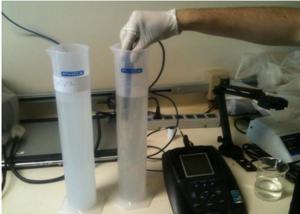
Figura 40 - Análise de condutividade do fluido com floculante. Ao esquerda, jarra com floculante e à direita, jarra sem floculante.
