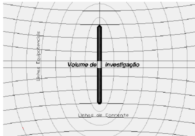
Figura 17 - As linhas equipotenciais e de corrente em sondas para medir resistividade com focalizadores.
