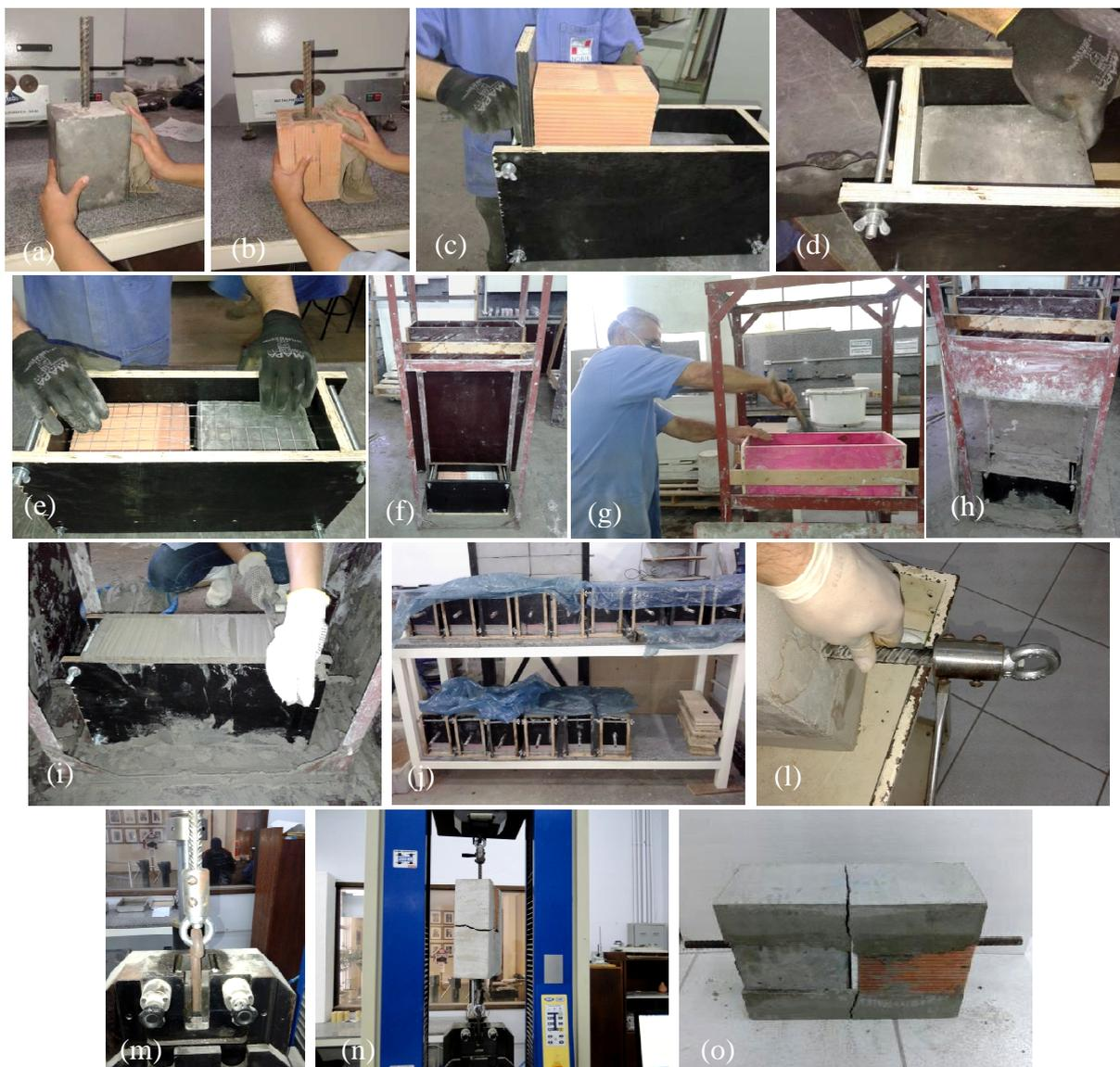
É importante informar que a escolha do meio-bloco cerâmico para representar a alvenaria se deu por conta da necessidade de um corpo de prova final com peso total possível de manusear em todas as etapas do experimento.
