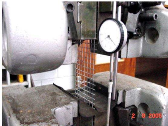
A melhoria da ligação e ancoragem da alvenaria com estrutura (pilar) tem sido promovida por muito tempo pelo uso de ferros de espera (ferro-cabelo) e, com mais frequência nos dias atuais pelo uso de tela metálica eletrossoldada. Neste aspecto, o sucesso da fixação lateral depende muito da eficiência das técnicas de ligação entre os dois subsistemas.
