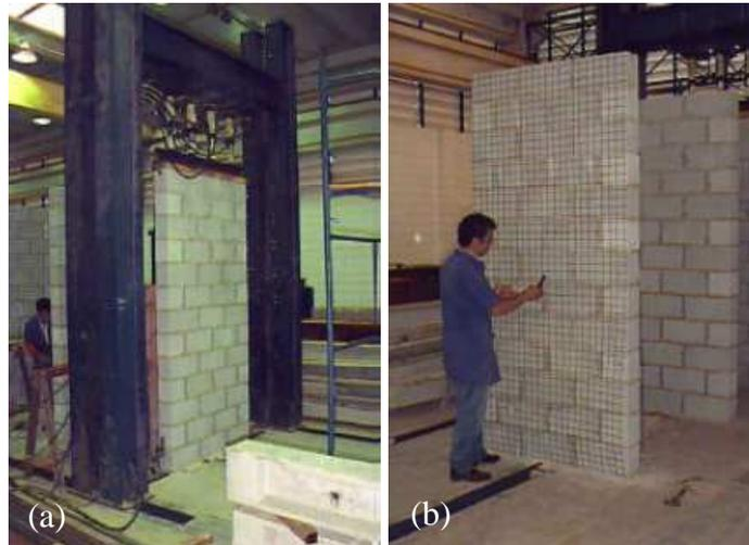
No seu ensaio adotou corpos de prova com as dimensões mínimas recomendadas por norma, com dimensões de (1,20 x 2,60) m, e aplicou a carga por meio de quatro macacos hidráulicos uniformemente espaçados com capacidade individual de 250 kN.
