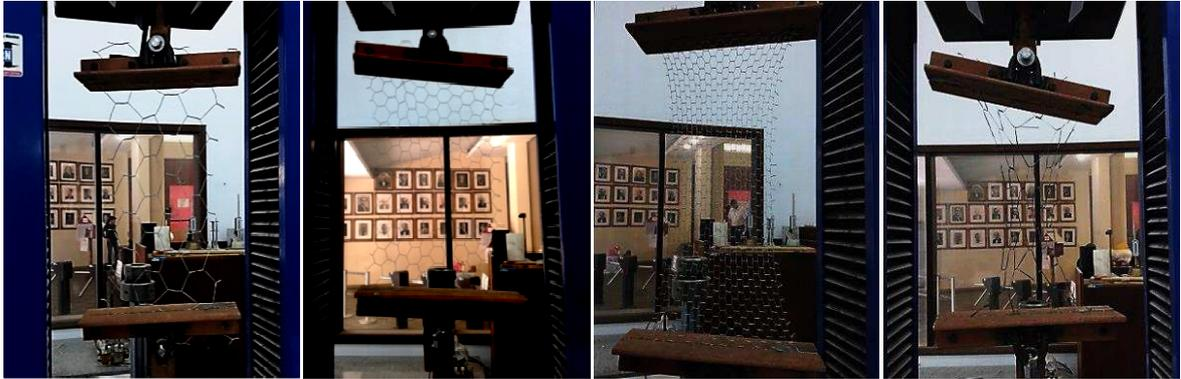
Para realização do mesmo, utilizou-se uma máquina de ensaios universais da marca SHIMADZU, modelo UH-F 2000KN, disponível no LEME (Laboratório de Ensaios e Modelos Estruturais) / UFRGS. O ensaio foi efetuado com temperatura de  $23 \pm 2$  °C e umidade controlada de  $60 \pm 5$  %.
