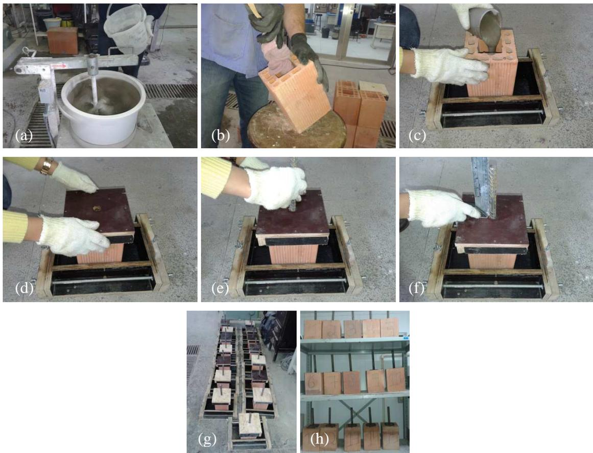
Para moldagem da argamassa de graute industrializada, adicionou-se apenas água e adotou-se tempo de mistura de 4 min, seguindo-se a instrução sugerida pelo fabricante. Para o saco de 25 kg utilizou-se 3,0 litros de água. A caracterização da argamassa industrializada de graute fornecida pelo fabricante encontra-se na tabela 8.
