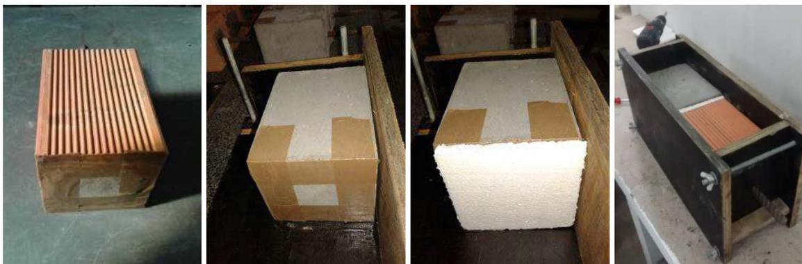
A metodologia proposta apresentou algumas limitações processuais como a massa elevada das amostras, especialmente após a aplicação de argamassa sobre a segunda face. O peso total do corpo de prova revestido pelos dois lados dava algo em torno de 28 kg. Desta forma, tanto por questões ergonômicas, como por medida de segurança às pessoas e aos corpos de prova, os manuseios destes foram sempre realizados por duas pessoas, conforme mostra a figura 58.
