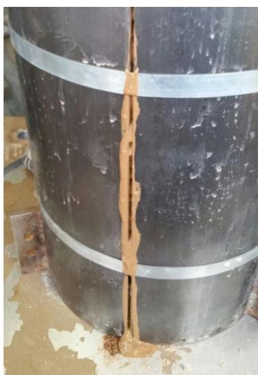
Figura 73 – Água livre não absorvida em amostra teste da distribuição UP Escalpo sem umedecimento prévio.
