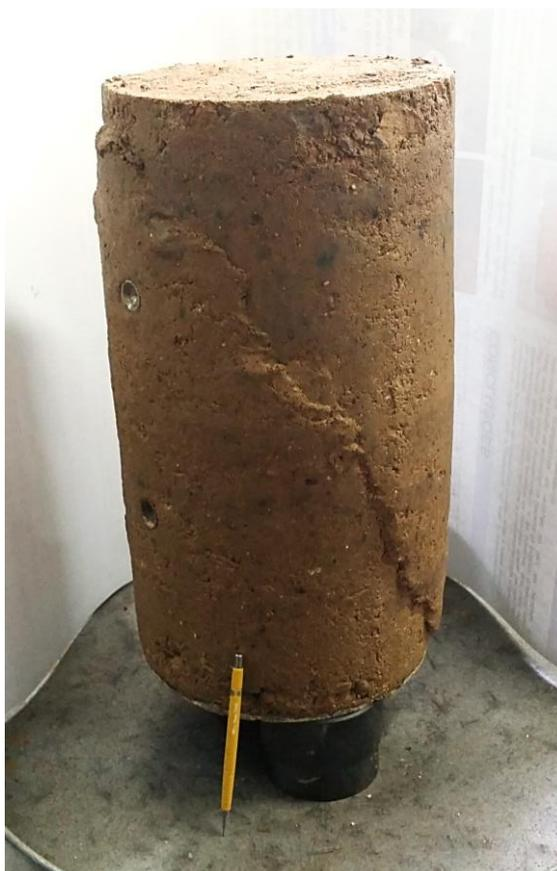
Figura 93 – Superfície de ruptura de uma amostra de 25 x 50 cm submetida ao ensaio triaxial de resistência ao cisalhamento em estágio único (GP1 – 100 kPa).
