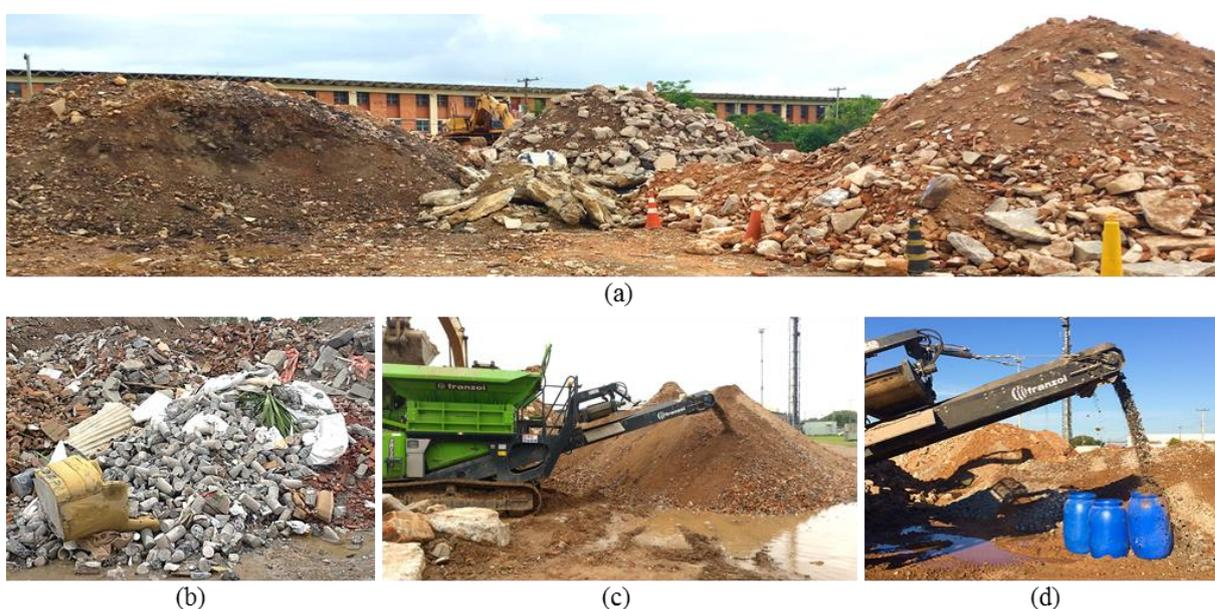
Figura 52 – Procedimentos adotados na unidade privada: (a) recebimento e estocagem do RCD de classe A conforme constituição predominante (derivados de infraestrutura, derivados de concreto e resíduos de composição mista, respectivamente); (b) triagem para retirada de resíduos de outras classes ou rejeitos; (c) britagem e separação conforme constituição e (d) coleta dos RCD mistos para pesquisa.
