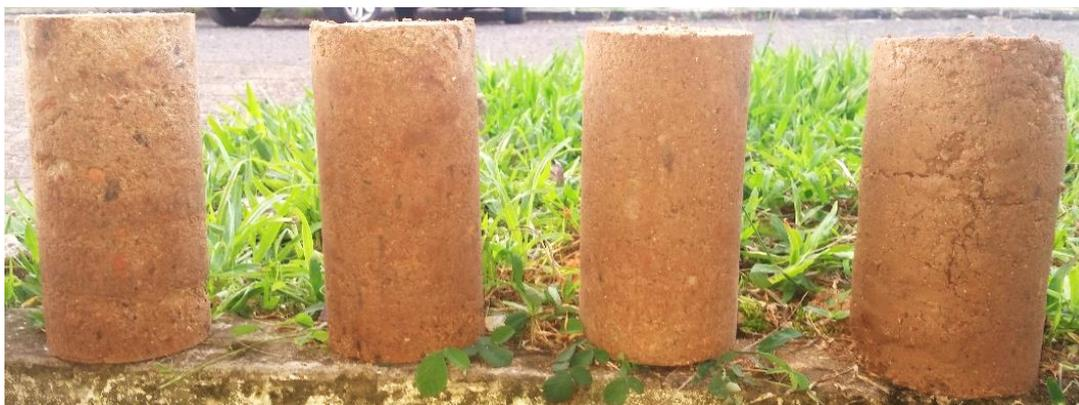
Figura 113 – Corpos de prova de 10 x 20 cm após ensaios de deformação permanente em multiestágios; utilizados para as tensões de confinamento de 21, 35, 53 e 70 kPa, respectivamente da esquerda para direita.
