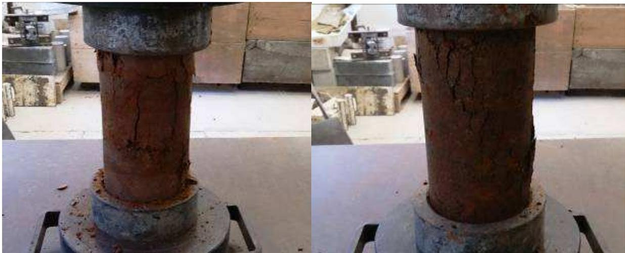
Figura 13 – Corpos de prova após os ensaios de compressão
