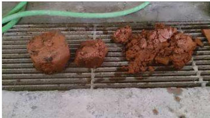
Figura 21 - Corpos de prova inviabilizados pelo contato com água
