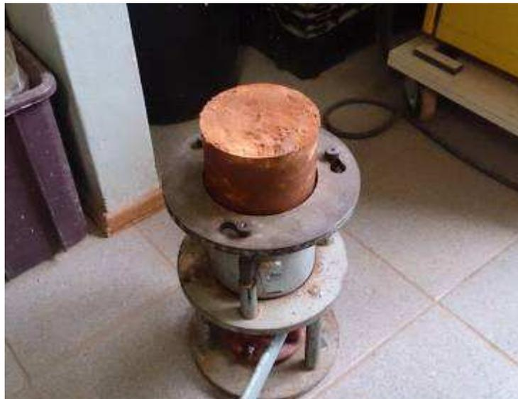
Figura 10– Desmoldagem do CP com auxílio de macaco hidráulico
