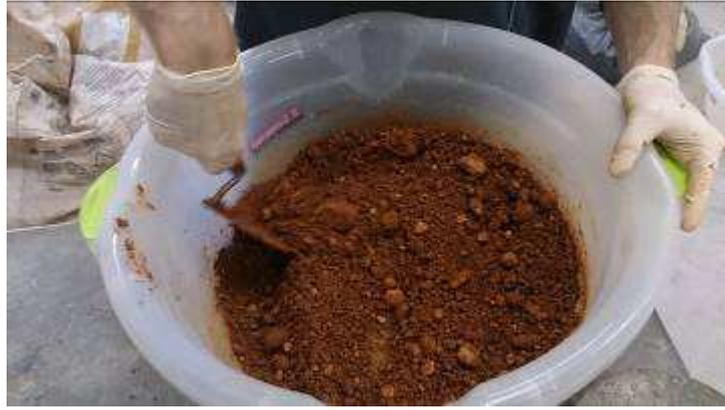
Figura 11 - Preparação da mistura de fresado asfáltico, solo laterítico e cimento
