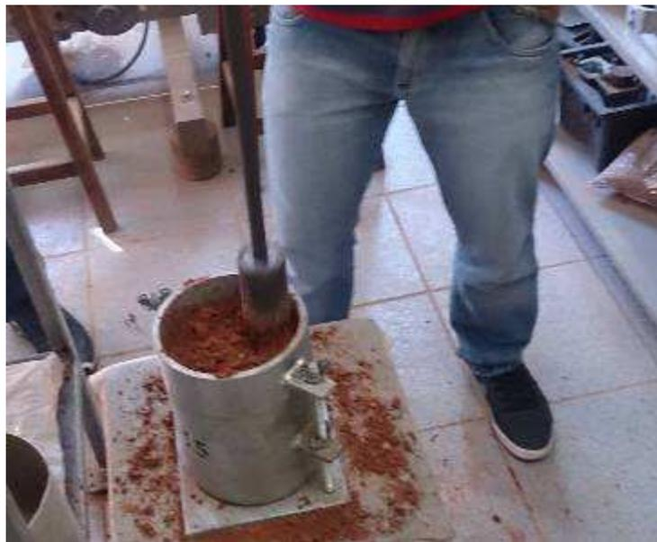
Figura 9 - Compactação dos CPs para obtenção da umidade ótima
