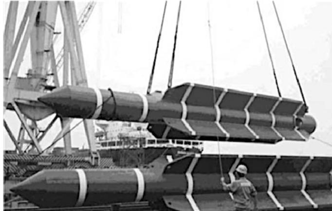
Figura 1.5 – Âncora torpedo (Bonfim dos Santos et al., 2004).
