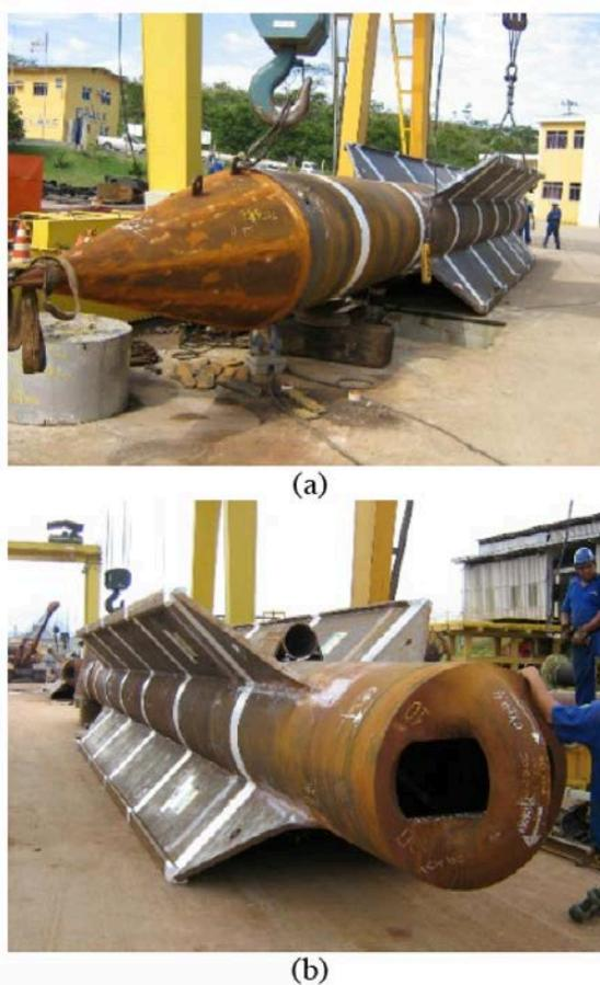
Figura 2.7 – Âncora torpedo típica: a) ponta cônica; b) olhal no topo (Sagrilo et al., 2010).
