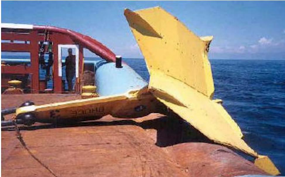
Figura 1.3 –VLA ou Âncora de arraste (Randolph et al., 2005).
