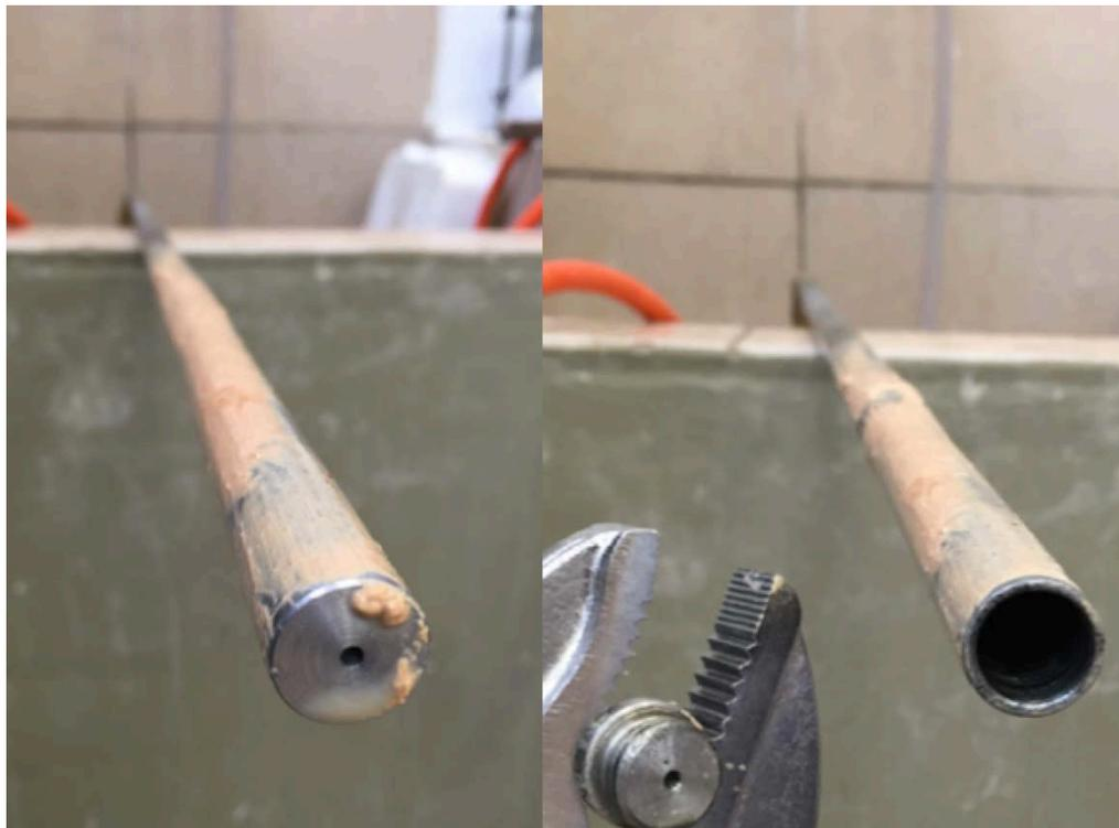
Figura 4.35 –Pormenor de ponta desobstruída de haste depois de ensaio de arrancamento.
