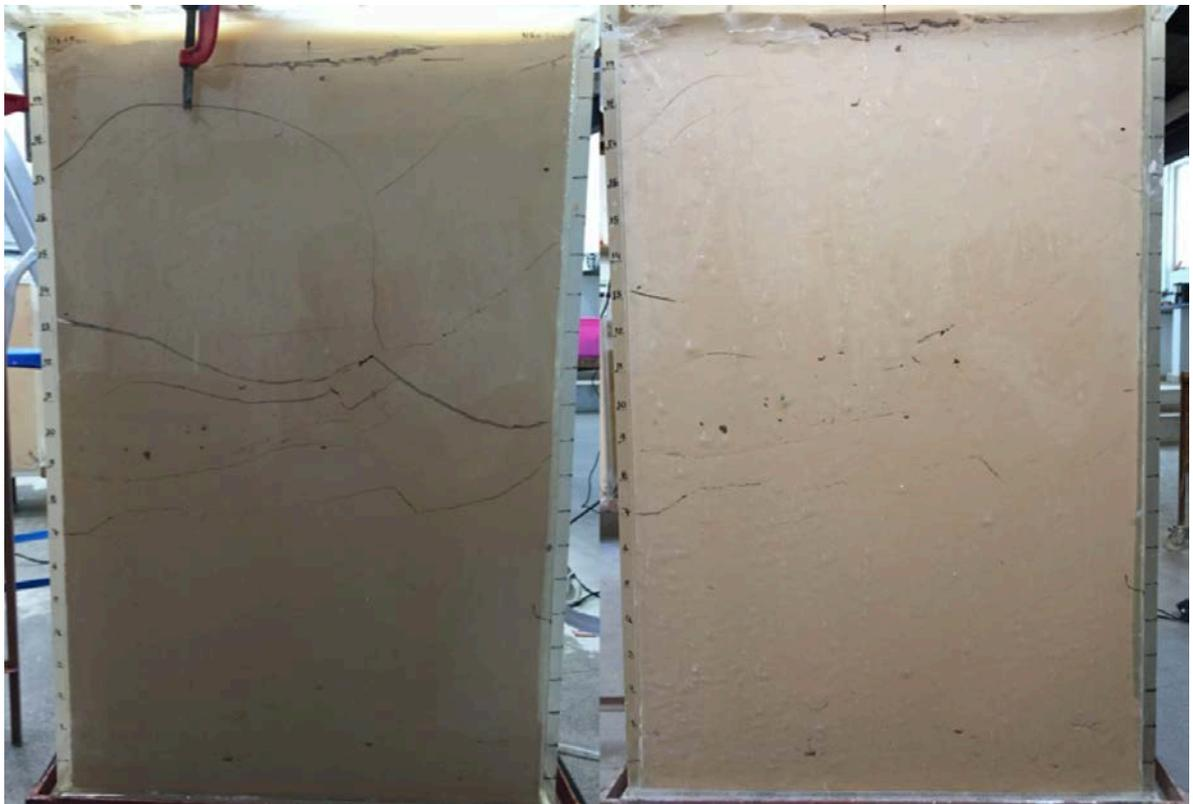
Figura 4.24 – Fraturas hidráulicas formadas durante ensaio (esq.) e seu fechamento quatro minutos após o término do ensaio (dir.).
