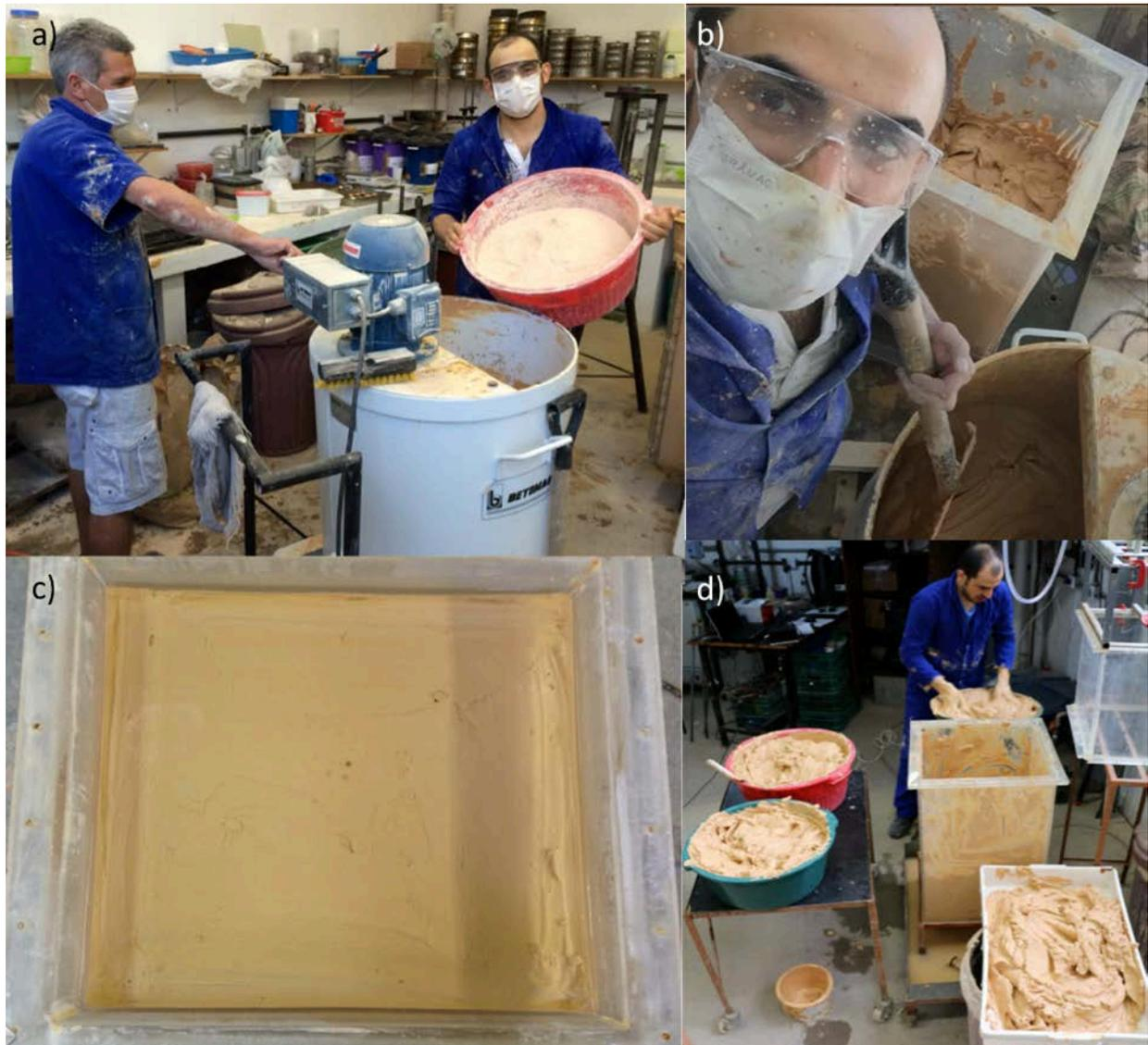
Figura 3.32 –Preparação das amostras de solo: a) mistura dos materiais; b) colocação no tanque; c) vista superior do tanque cheio e com lâmina de água; d) remistura do solo.
