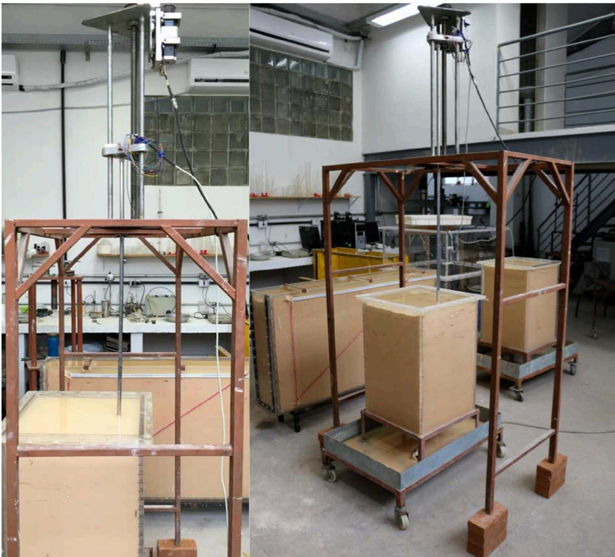
Figura 3.25 – MCPTU acoplado ao sistema de cravação durante ensaios.
