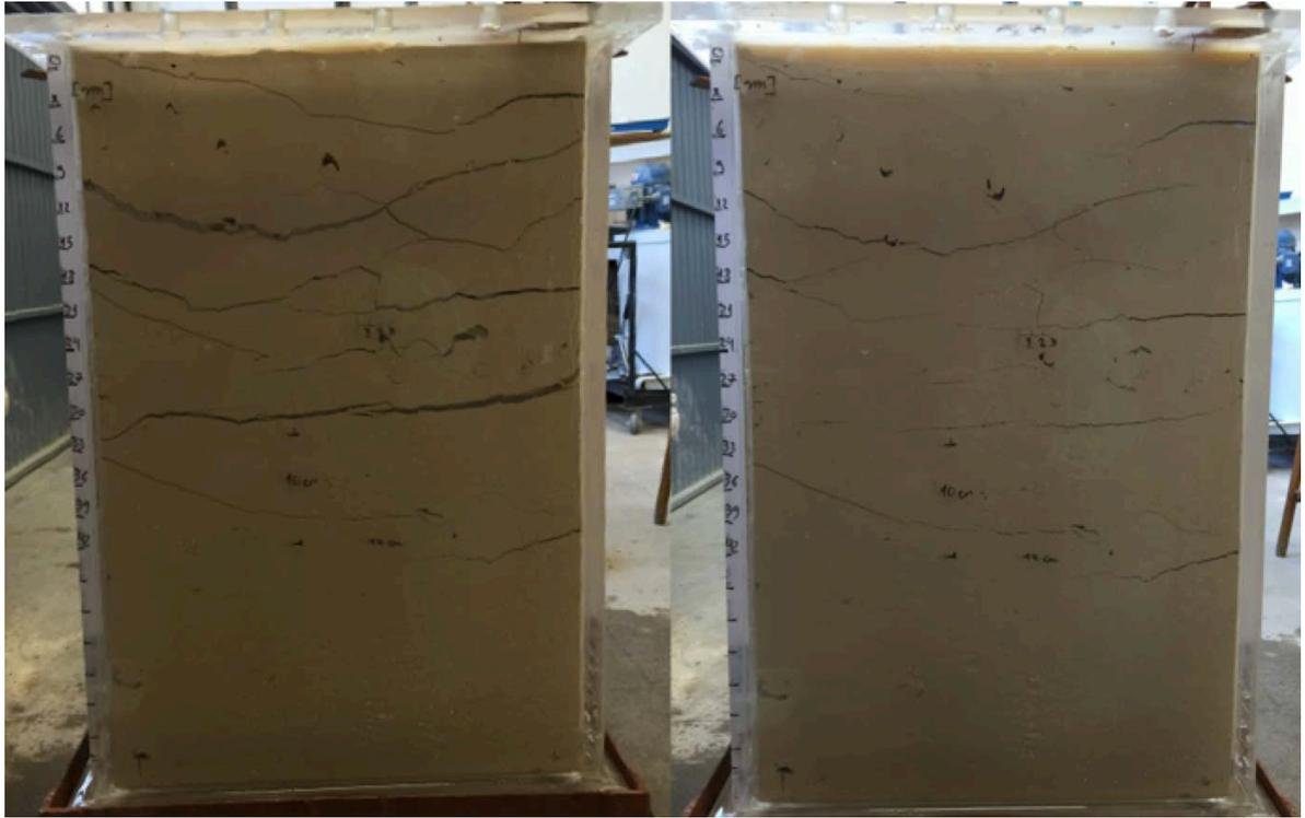
Figura 4.23 – Fraturas hidráulicas formadas durante ensaio (esq.) e seu fechamento um minuto após o término do ensaio (dir.).
