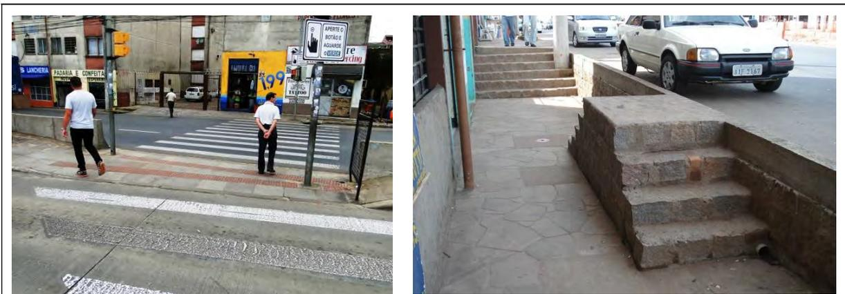
Porto Alegre, corredor de ônibus na avenida Balthazar de Oliveira Garcia, foi construído cuidados relativos à acessibilidade (foto da esquerda), exceto nos passeios laterais, onde as condições existentes demonstram falta de acessibilidade universal (foto da direita).
