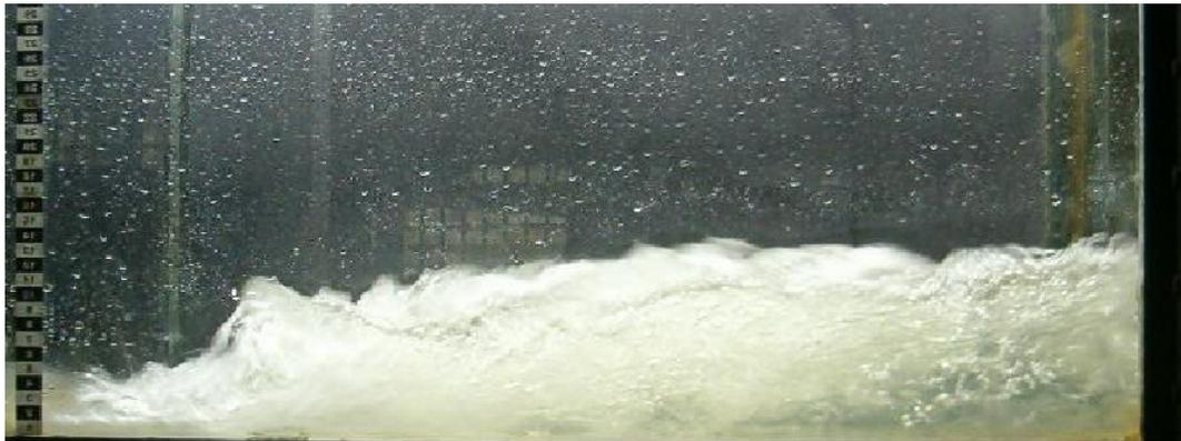
Figura 2.1: Ressalto Hidráulico Clássico.
