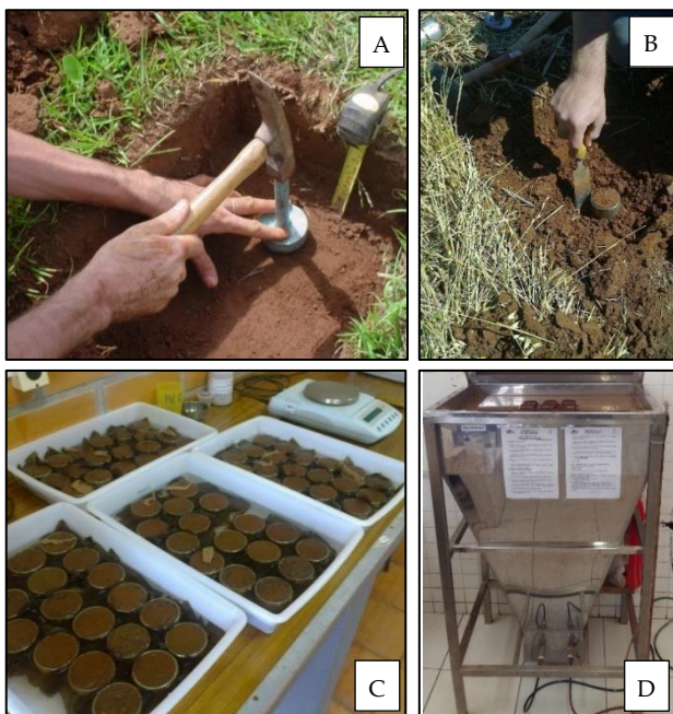
Figura 42. Coleta e preparo de amostras de solo com estrutura preservada: inserção do cilindro ao solo com o extrator (A), extração do cilindro com auxílio de espátula (B), amostras de solo saturada, com o fundo revestido por tecido voál e balança (C), e mesa de tensão com areia (D). Fonte: Pellegrini (2015).
