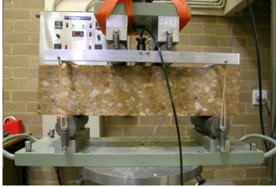
Figura 16. Configuração de ensaio quatro pontos: RTF, MRF e fadiga (AUSTROADS, 2008)
