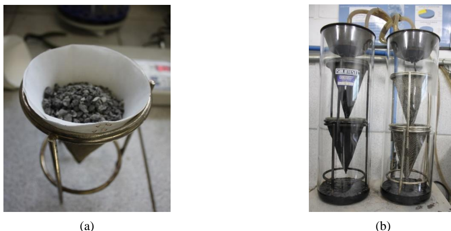
Figura 32. Ensaio de refluxo: (a) preparação de amostra, (b) após cinco dias de andamento
