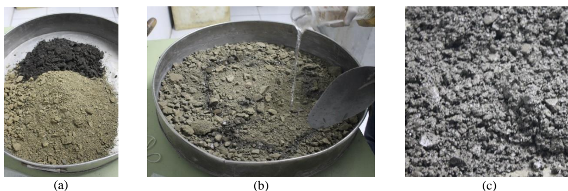
Figura 33. Mistura materiais (a) brita graduada simples e fresado, (b) adição de água após adição e mistura do cimento, (c) mistura homogênea (6 % cimento, 20 % de fresado)
