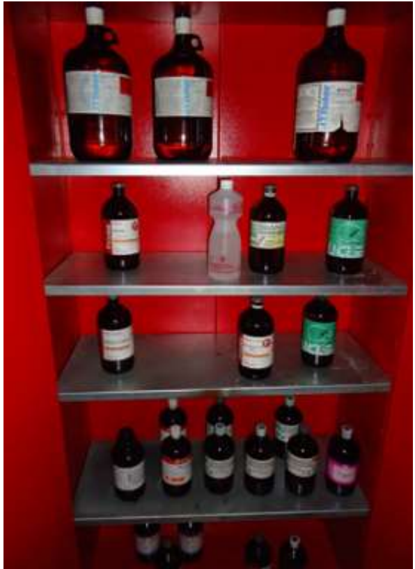
Figura 4.13: Reagentes estocados seguindo os critérios de compatibilidade e em armários corta-fogo. LADETEC.
