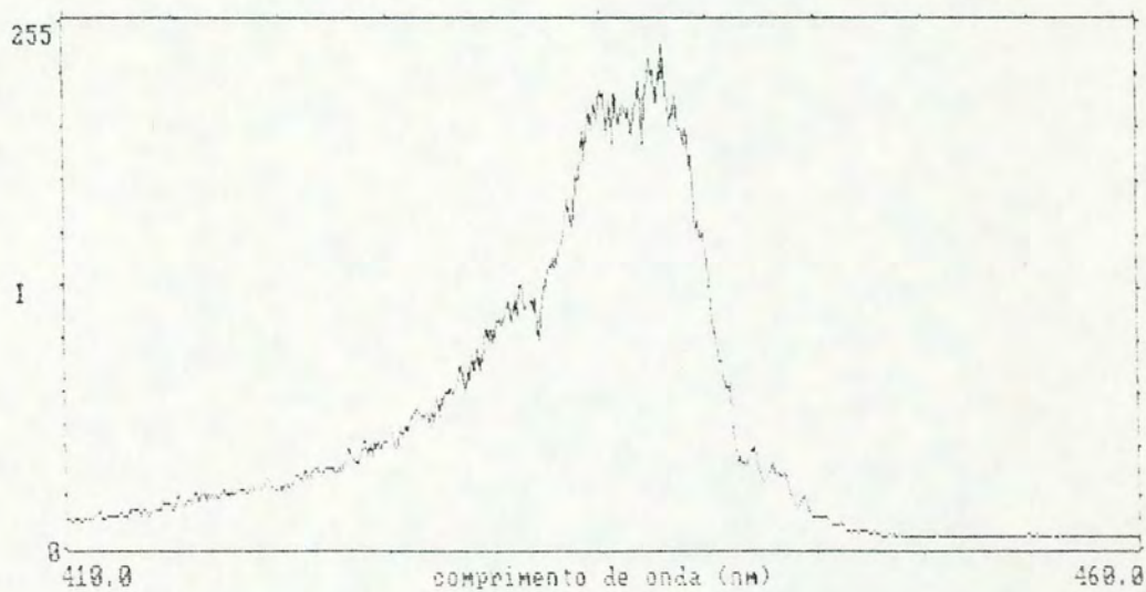
FIGURA 4.7 Nesta figura é mostrada o espectro obtido, nas mesmas condições da figura 4.6, mas com temperatura de 900K
