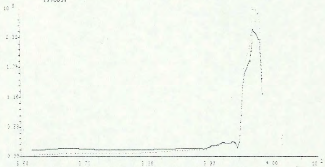
FIGURA 4.4 Espectro calculados para a transição 4^3P_0 - x^3\Sigma_u^+ , a partir das curvas de energia potencial calculadas por Jeung [1988].
