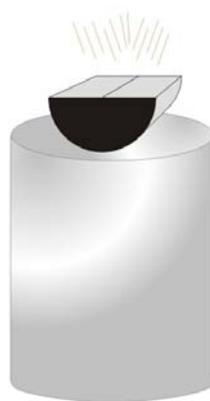
Figura 4.19: CP fraturado e colado em stub, observando a área de fratura voltada para cima, bem com a marcação em preto (indicação onde recebeu ação da luz fotoativadora)
