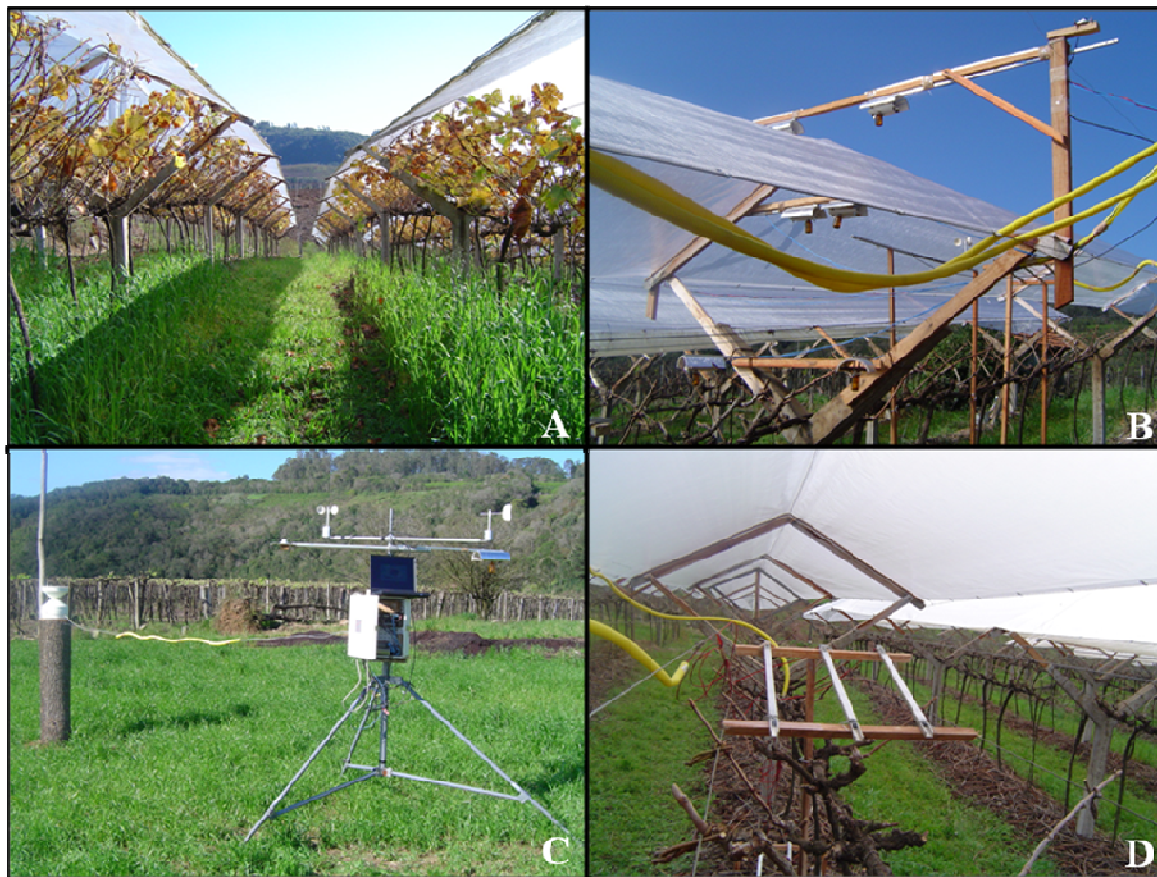
FIGURA 3. Vinhedo e equipamentos para caracterização de meso e microclima. Vinhedo no outono sob cobertura plástica impermeável sobre as linhas de cultivo (A), disposição de pares psicrométricos (B), estação automática (C) e barras para medição de radiação fotossinteticamente ativa, cada uma composta com cinco células de silício amorfo (D). Flores da Cunha, RS. 2005.
