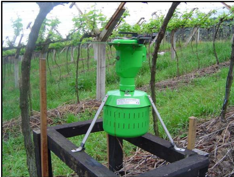
FIGURA 4. Coletor de esporos tipo Burkard posicionado em vinhedo coberto da cultivar ( Vitis vinifera L.) Moscato Giallo. Flores da Cunha, RS. 2005.
