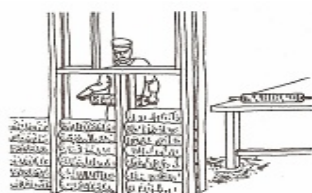
Enchimento de um tramo de enxaimel pela técnica de rolo de barro e palha (Minke, 1994, p.101).
