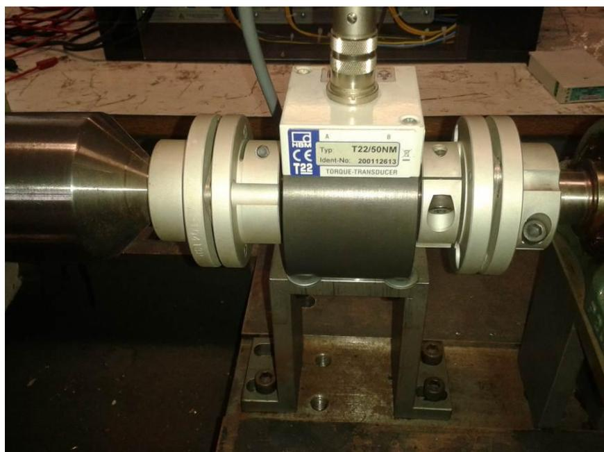
**Figura 80** Torquímetro da HBM de 50 Nm.
