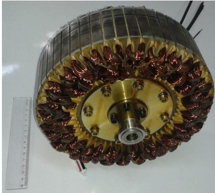
**Figura 78 Estator do protótipo bobinado, com saída das três fases e do fechamento da estrela.**
