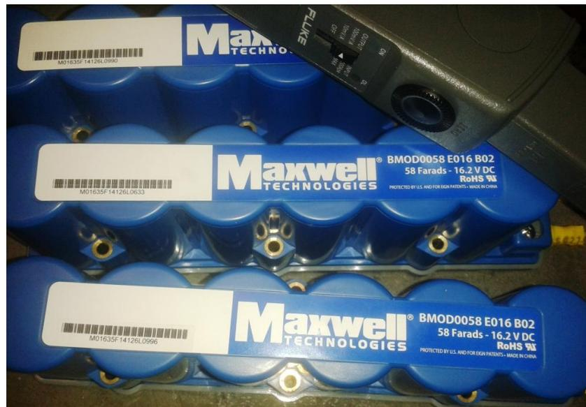
**Figura 96 Banco de supercapacitores utilizados nos ensaios de frenagem regenerativa.**
