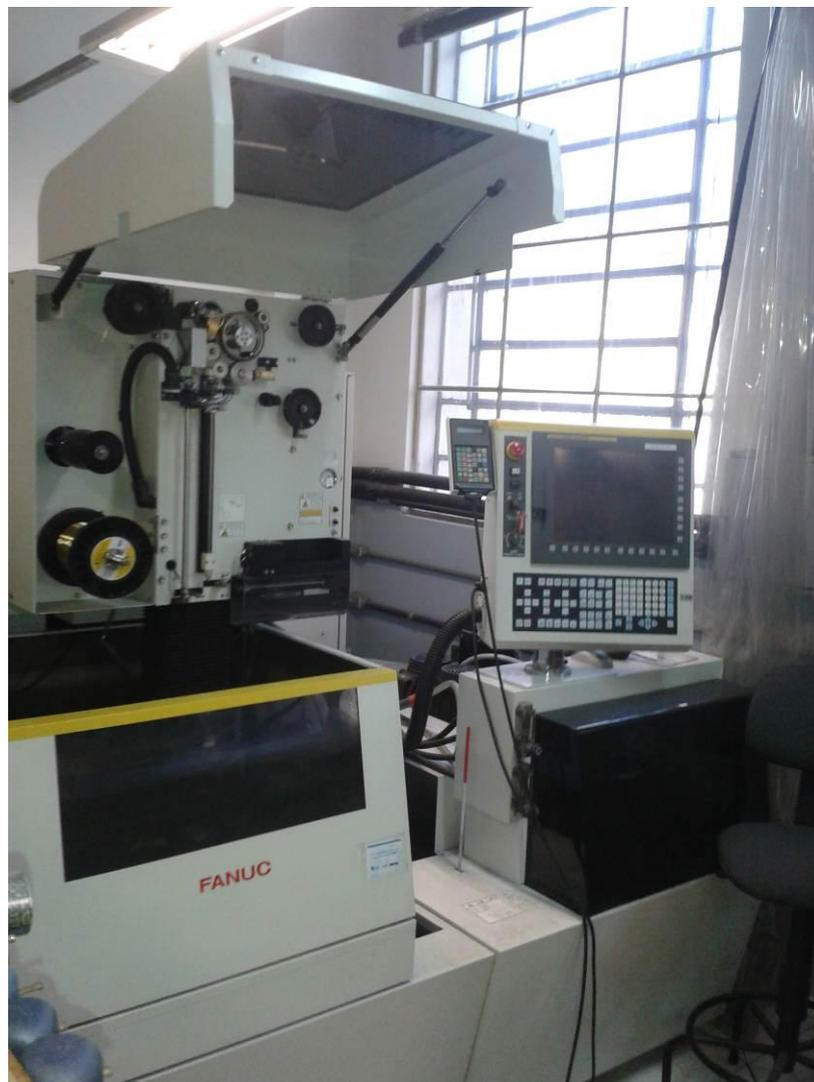
**Figura 63** Máquina de eletro erosão a fio da Fanuc.
