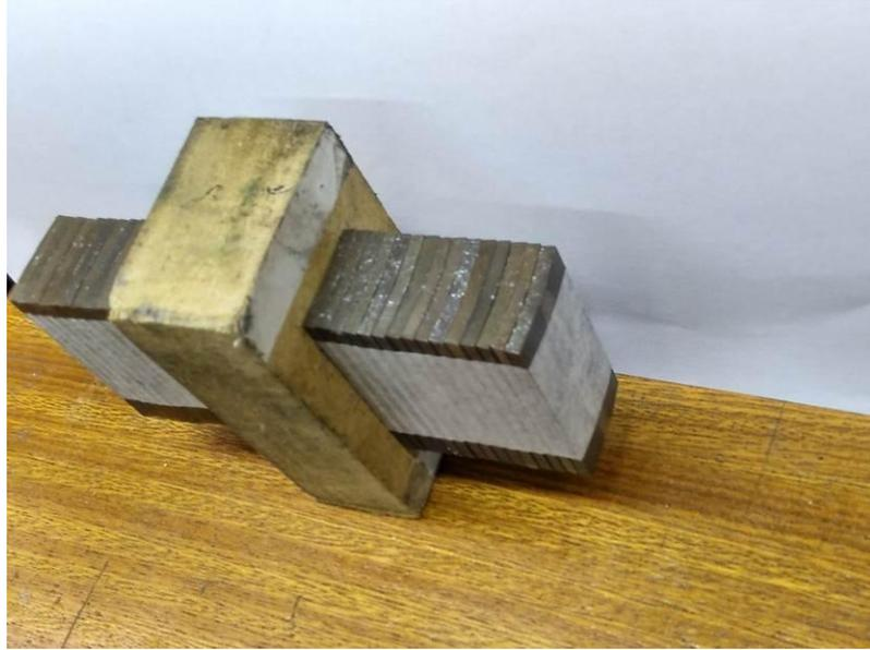
**Figura 71** Ímãs permanentes após a magnetização.
