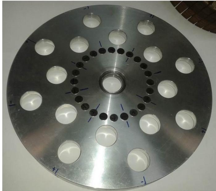
**Figura 73 Tampa do rotor com pastilhas de NdFeB de 10 mm x 1mm para leitura do transdutor de posição.**
