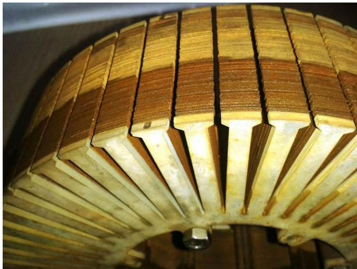
**Figura 68 Corte das chapas do estator da máquina.**
