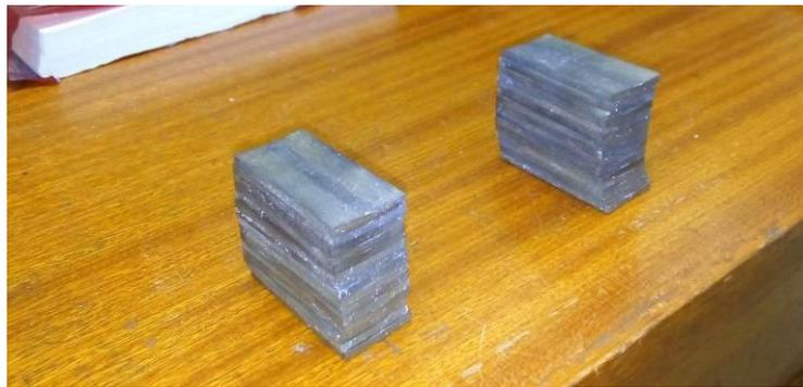
**Figura 70** Ímãs permanentes cortados e desmagnetizados.
