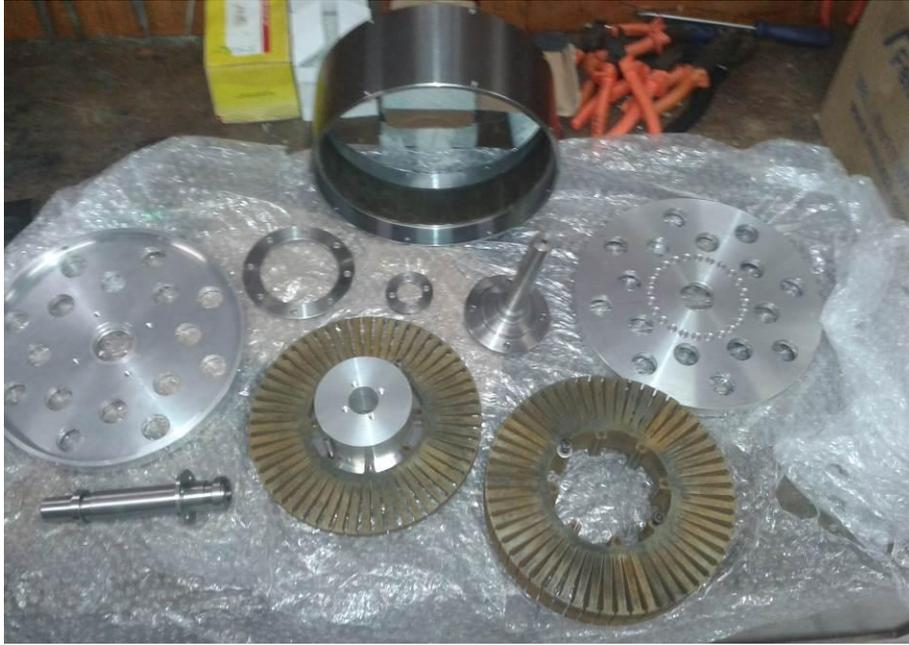
**Figura 74** Conjunto de peças integrantes do protótipo antes de iniciar a montagem.
