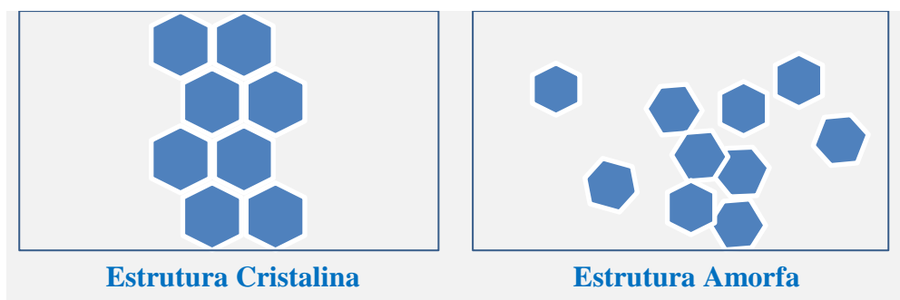
Figura 1 – Representação de estruturas cristalina e amorfa (Adaptado de Cuffini; Pitaluga; Tombari, 2011).
