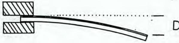
Figura 2.20: A deflexão da extremidade livre com a aplicação de um campo magnético é proporcional à magnetostricção.
