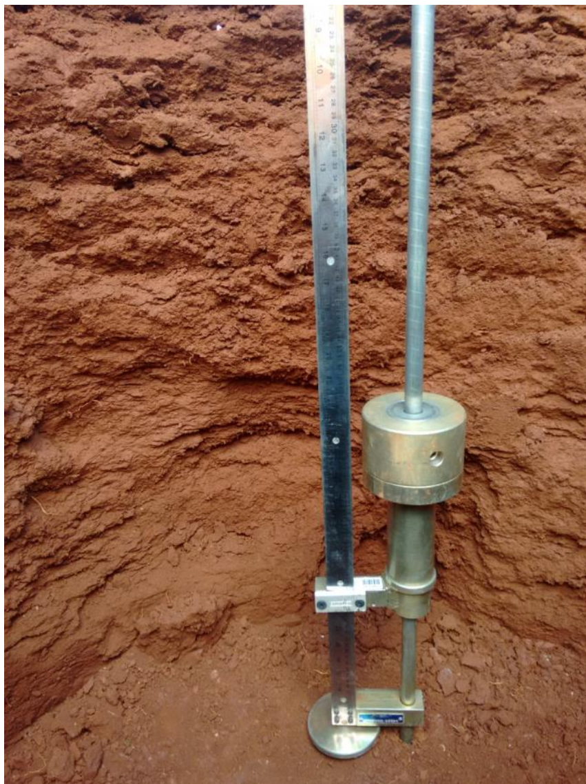
Figura 3.11 – DCP já cravado no fundo da cratera.
