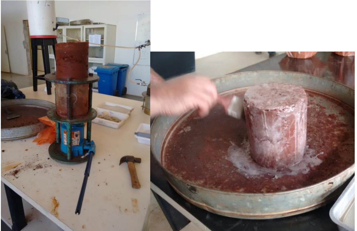
Figura 3.9 – Amostras retiradas dos cilindros (esquerda) e após a retirada, sendo parafinadas (direita)
