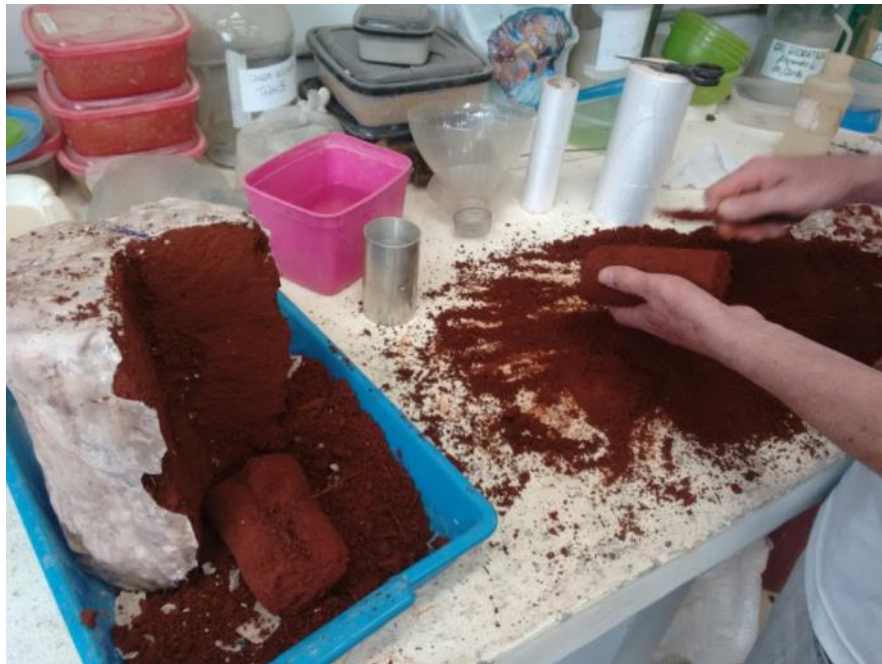
Figura 3.10 – Moldagem dos corpos de prova.
