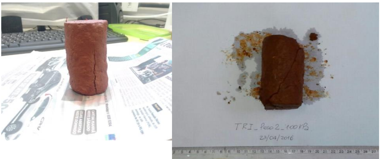
Figura 4.11 – Ruptura solo natural (esquerda) vs ruptura solo compactado (direita)
