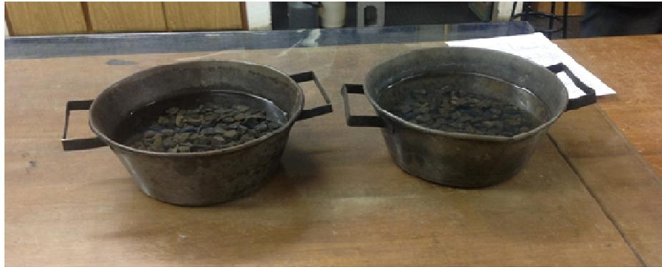
Figura 3.7 – Amostra de agregado graúdo submerso
