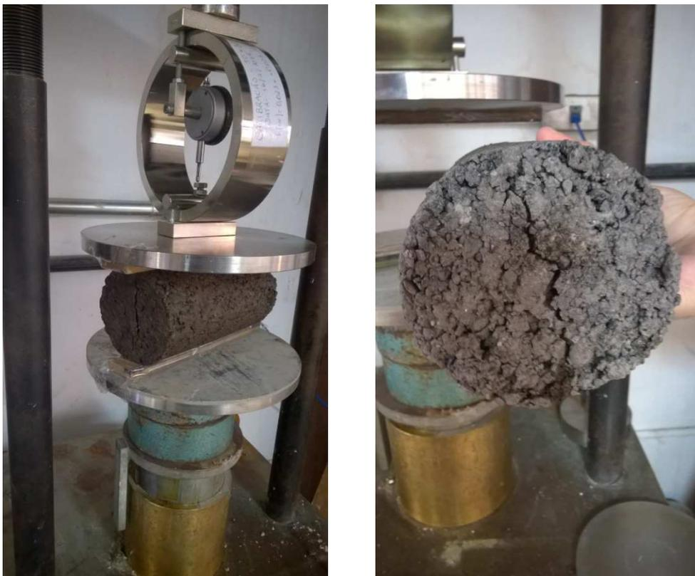
Figura 4.10 – Plano de ruptura no plano longitudinal
