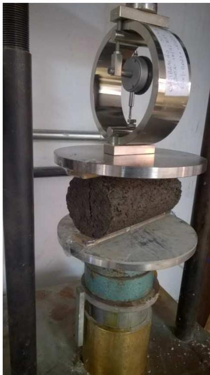
Figura 3.14 – Corpo-de-prova de 10 x 20 cm ensaiado à Tração
