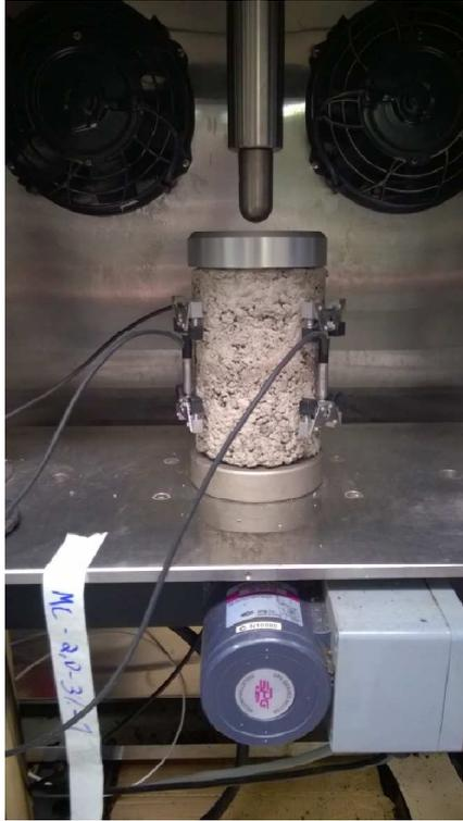
Figura 3.18 – Corpo de prova instrumentado
