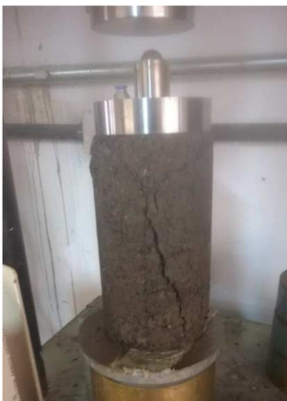
Figura 4.5 – Plano de ruptura
