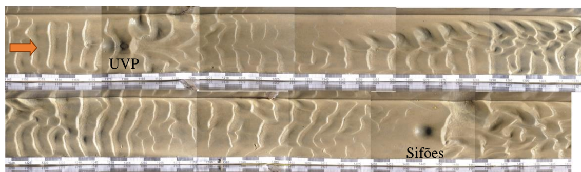
Figura 53. Influência das sondas UVP e sifões na deformação das cristas das formas de fundo do ensaio 1,5PQ3.
