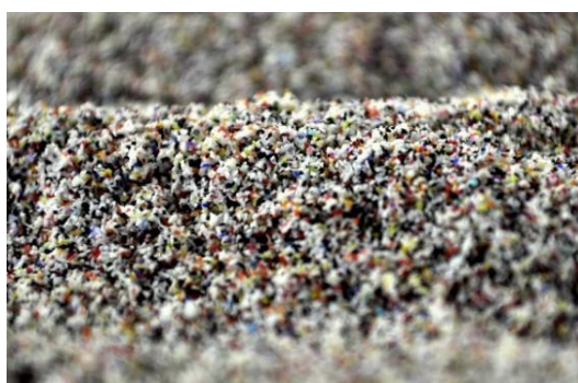
Figura 18. Material granular plástico utilizado na composição do leito móvel do canal.
