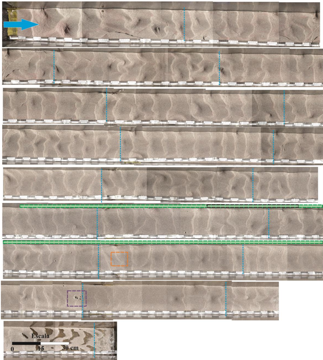
Figura 70. Vista superior das formas de fundo do ensaio 1,5Mq1 ao longo do canal.
