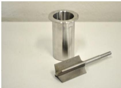
d) Cilindro Concêntrico com Copo Invertido - *Double Gap*
