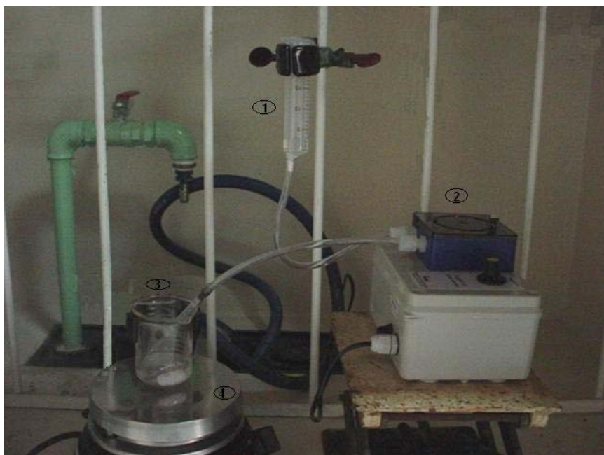
Figura 33: Sistema de reação de formação dos hidrogéis em meio aquoso: 1 – reservatório da solução de alginato e ou quitosana . 2 – bomba peristáltica que transfere a solução até o béquer; 3- béquer contendo solução de cálcio e 4- placa de agitação magnética.
