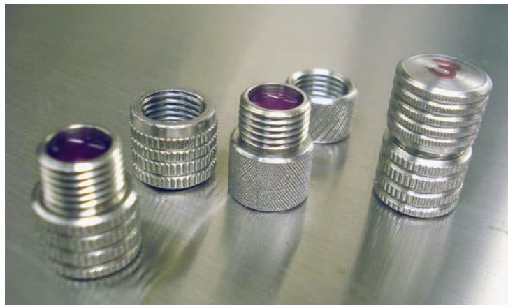
Figura 2. Cápsula de metal desenvolvida por Aquino et al. (2014) para criopreservação de sistemas biológicos.
