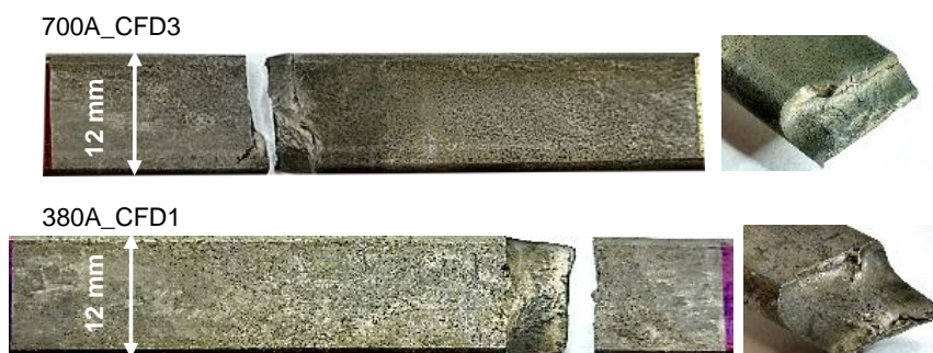
Figura 111 – Aspecto geral da fratura de amostras de testes de corrosão-fadiga em meio desaerado
