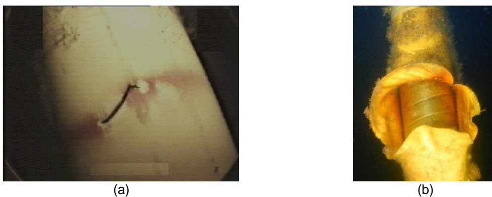
Figura 27 – Exemplos de danos em capa externa de duto flexível, (a) rasgo e (b) explosão
