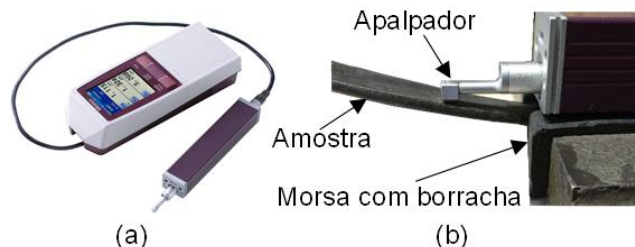
Figura 69 – Rugosímetro portátil e posicionamento para medição em arame
