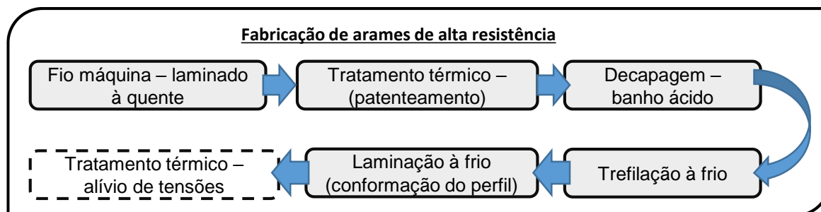
Figura 14 – Fluxograma do processo de fabricação de arames trefilados à frio após tratamento térmico de patentamento
