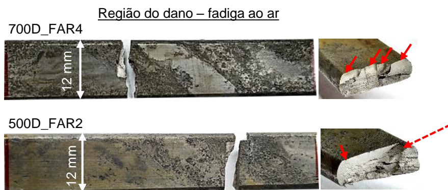
Figura 109 – Aspecto geral da fratura de amostras de testes de fadiga ao ar
