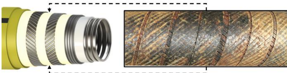
Figura 22 – Fita anti-atrito sobre a armadura de tração.
