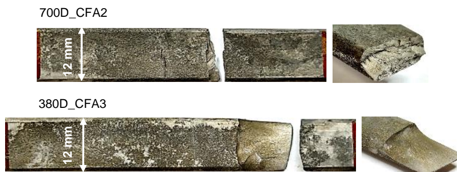
Figura 110 – Aspecto geral da fratura de amostras de testes de corrosão-fadiga em meio aerado
