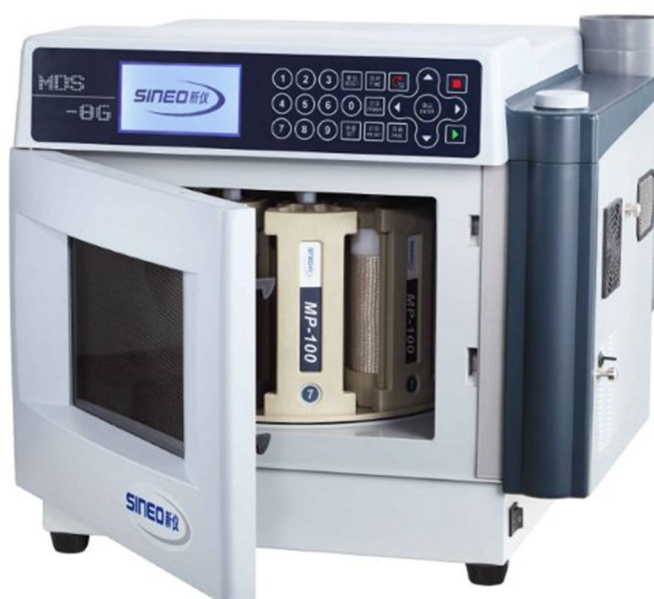
Figura 5.2 – Equipamento microondas com sistema de digestão/extração utilizado para o tratamento térmico das amostras sintetizadas neste trabalho.
