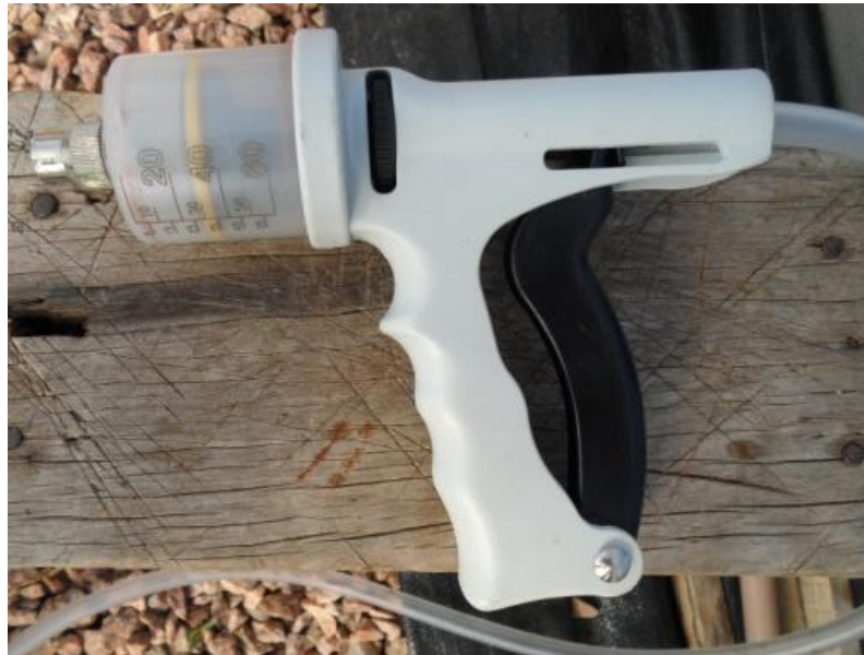
FIGURA 9. Dosador utilizado para aplicação da fertirrigação em plantas da espécie boca-de-leão ( Antirrhinum majus L.). Porto Alegre, 2013. Foto: Rafael Elgert, 2013.
