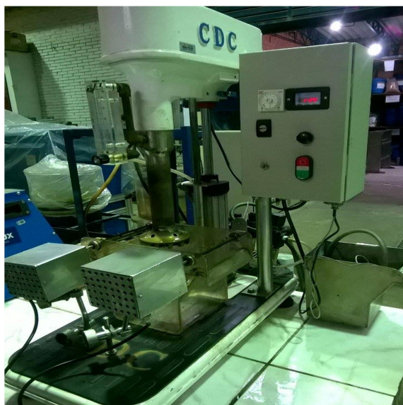
Figura 21. Máquina de flotação de bancada tipo CDC
