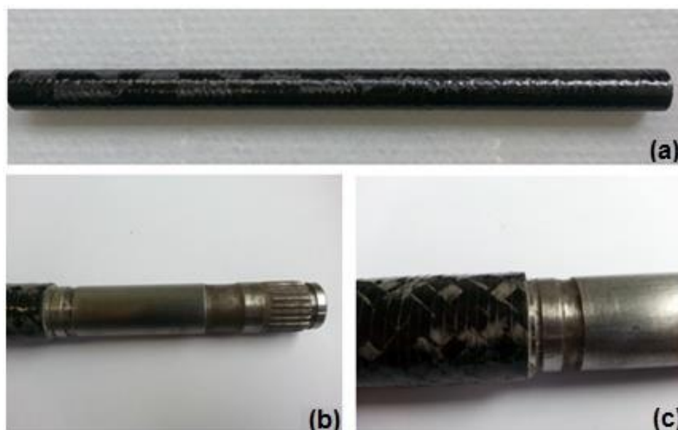
Figura 30 – Cilindro em compósito [\pm 45]_5 (a), inserto metálico (b) e união adesivada (c)
