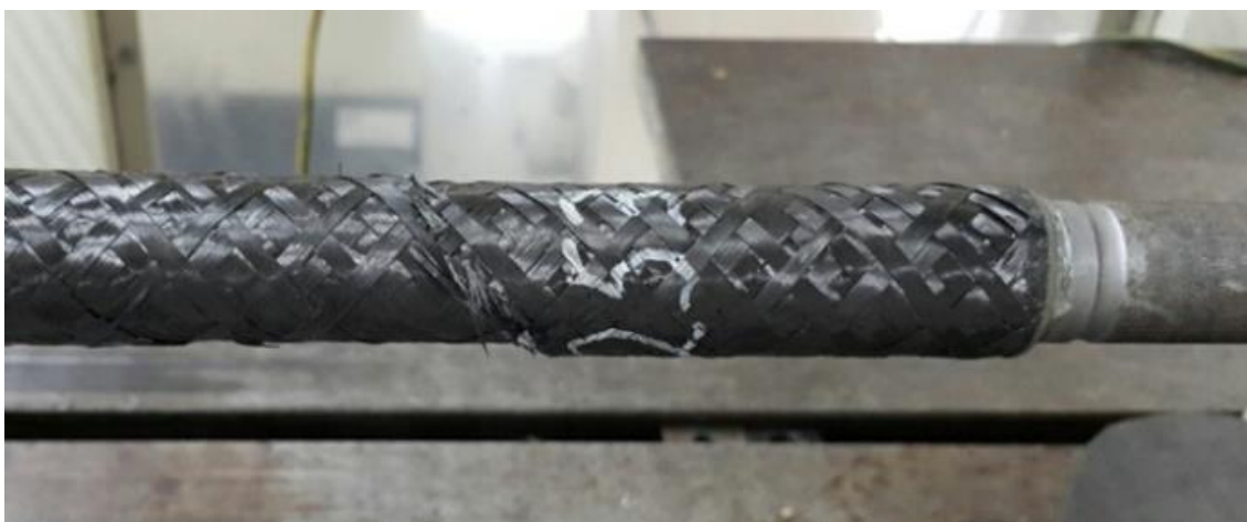
Figura 33 – Fratura do cilindro [\pm 45]_5 ensaiado.
