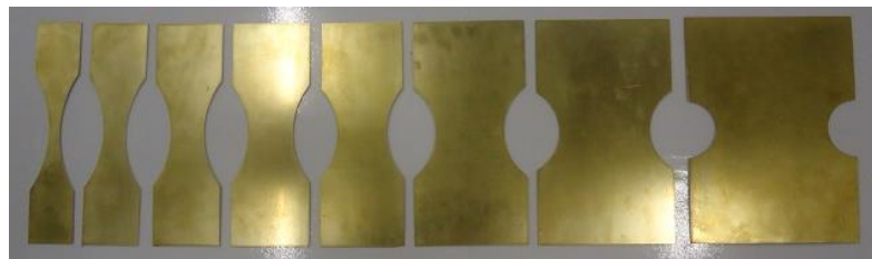
Figura 73: Corpos de prova lixados após o processo de corte a laser.
