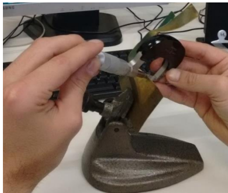
Figura 87: Medição das espessuras ( s_1 ) na região estampada
