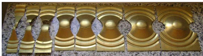
Figura 74: Corpos de prova com 1,00 mm de espessura após o ensaio CLC.
