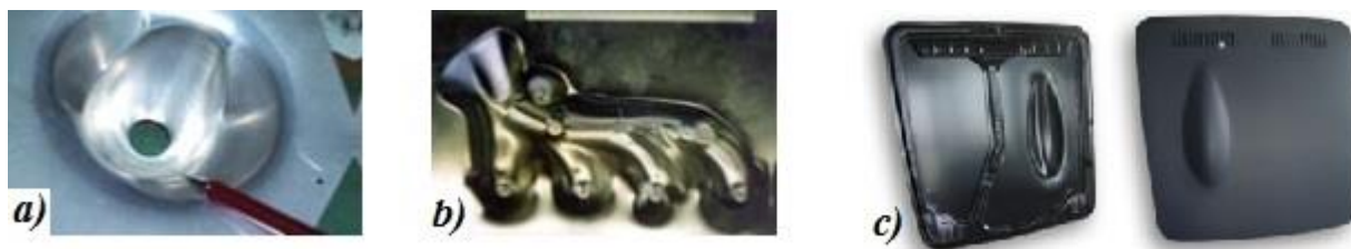
Figura 26: Aplicações da ISF: a) Superfície refletora para farol; b) Proteção Térmico/Ruído [27]; c) Capô dianteiro de automóvel [41]
