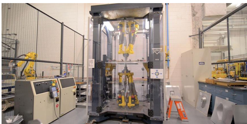
Figura 12: Equipamento de ISF utilizado no Ford Freeform Fabrication Technology [12].
