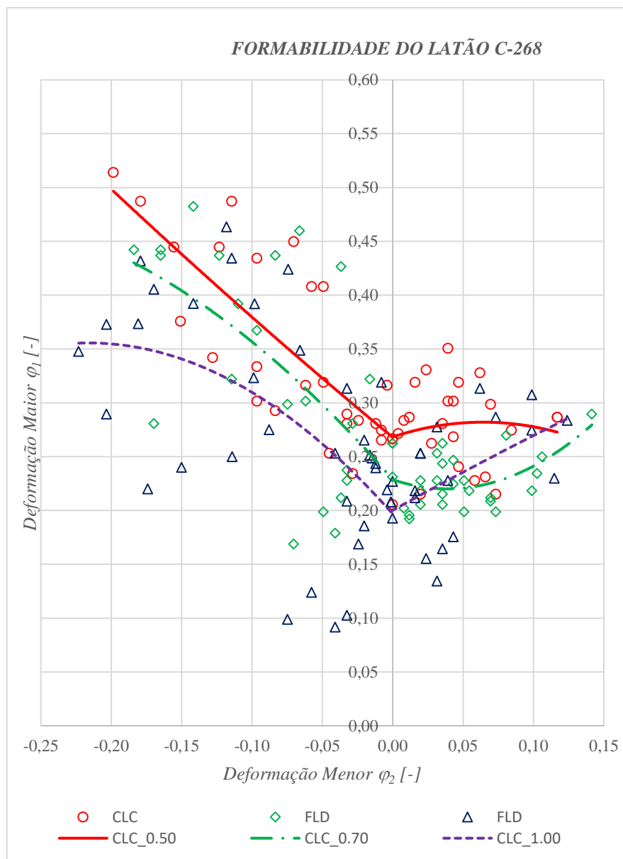
Figura 75: Curva CLC experimental do latão C-268.
