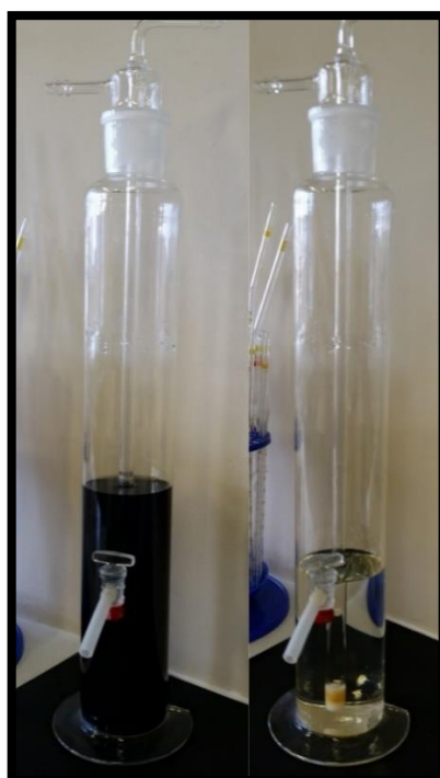
Figura 4.8: Solução aquosa de 50 \text{ mg L}^{-1} de AB-210 antes e após a de ozonização, em pH 11.
