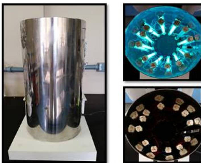
Figura 3.2: reator UV do Laboratório de Separação e Operações Unitárias do Departamento de Engenharia Química da UFRGS.
