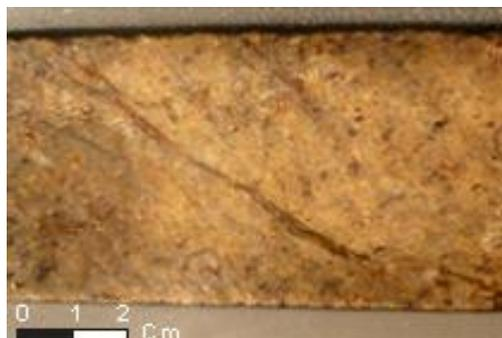
Abundantes fraturas subparalelas, preenchidas por criolita, óxidos ferruginosos e por materiais aparentemente argilosos com birrefringência semelhante à da mica.
