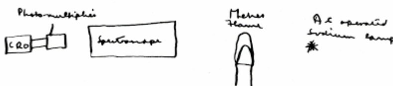
Figura 1: O primeiro esquema proposto por Alan Walsh, em 1952, para observar a absorção atômica de elementos. (Adaptado de Welz e Sperling 1 )
