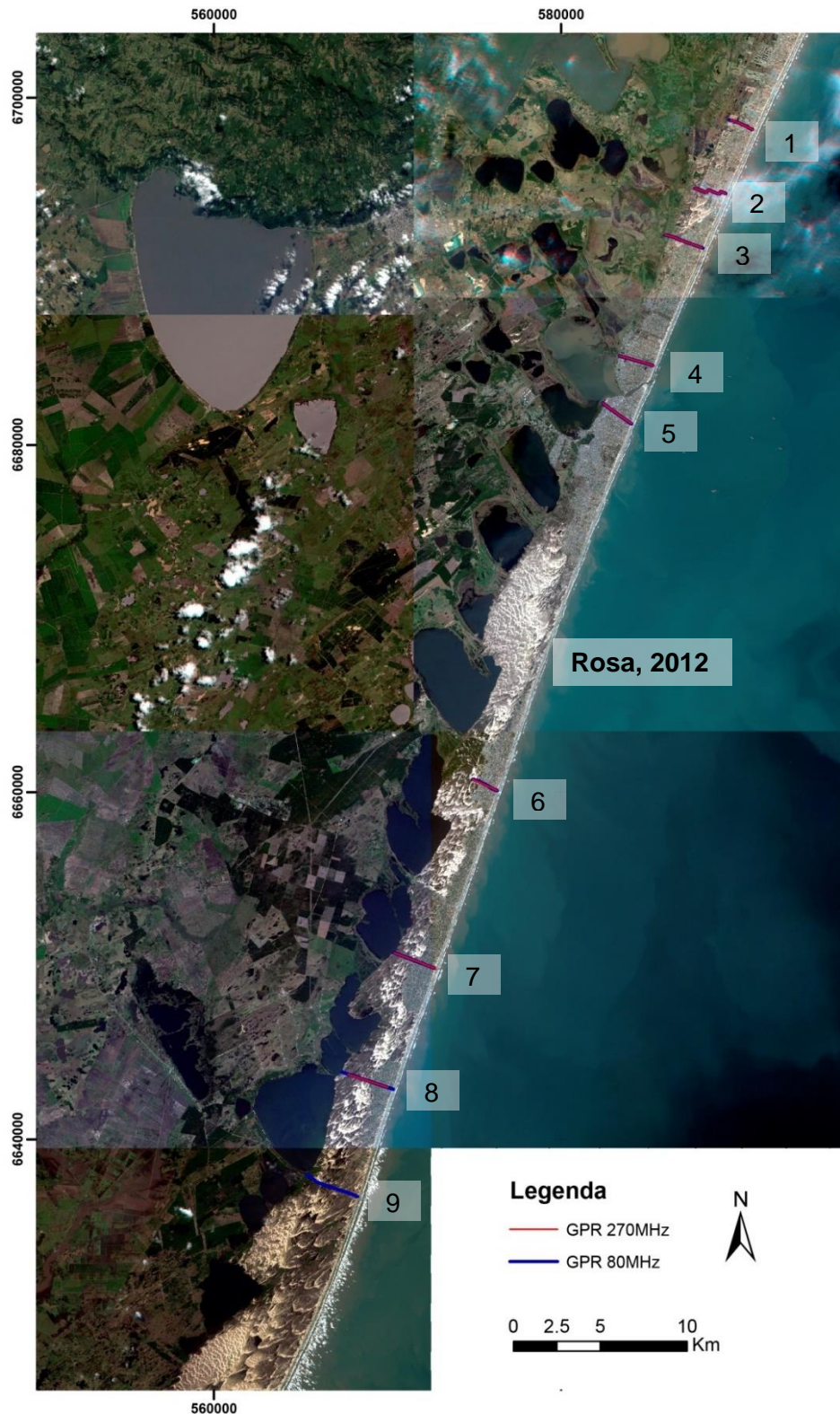
Figura 10. Localização das seções de GPR. Em vermelho, o posicionamento das seções adquiridas com antena de 270 MHz, em azul aquelas adquiridas com antena de 80 MHz. A numeração (1-9) refere-se ao posicionamento geográfico das seções e estão presentes na coluna de localização (Tabela 1). Na região central não foram coletados dados devido às seções pré-existentes na tese de Rosa (2012).
