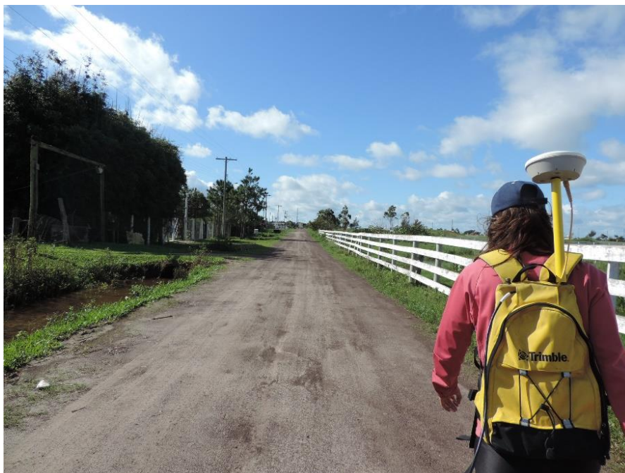
Figura 12. GNSS geodésico TRIMBLE® Pro-XRT (Perfis 10 e 11 com antena de 270 MHz – Imara).
