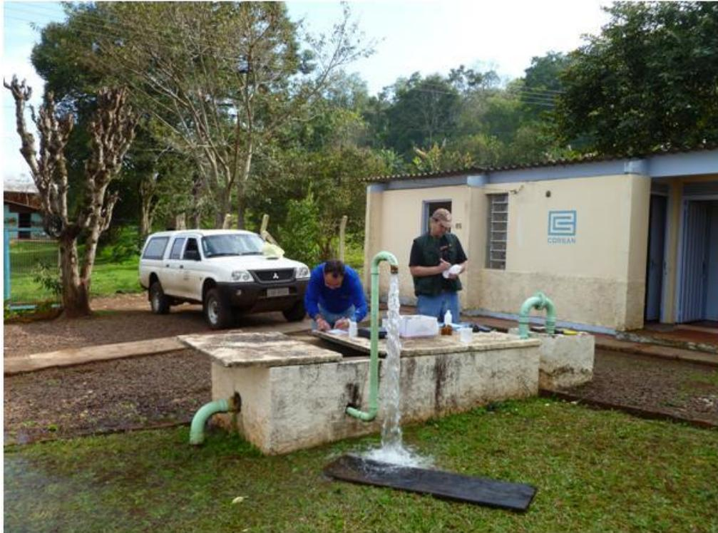
Figura 5. Expurga para coleta de água do poço JQ-499 em Vicente Dutra,RS.
