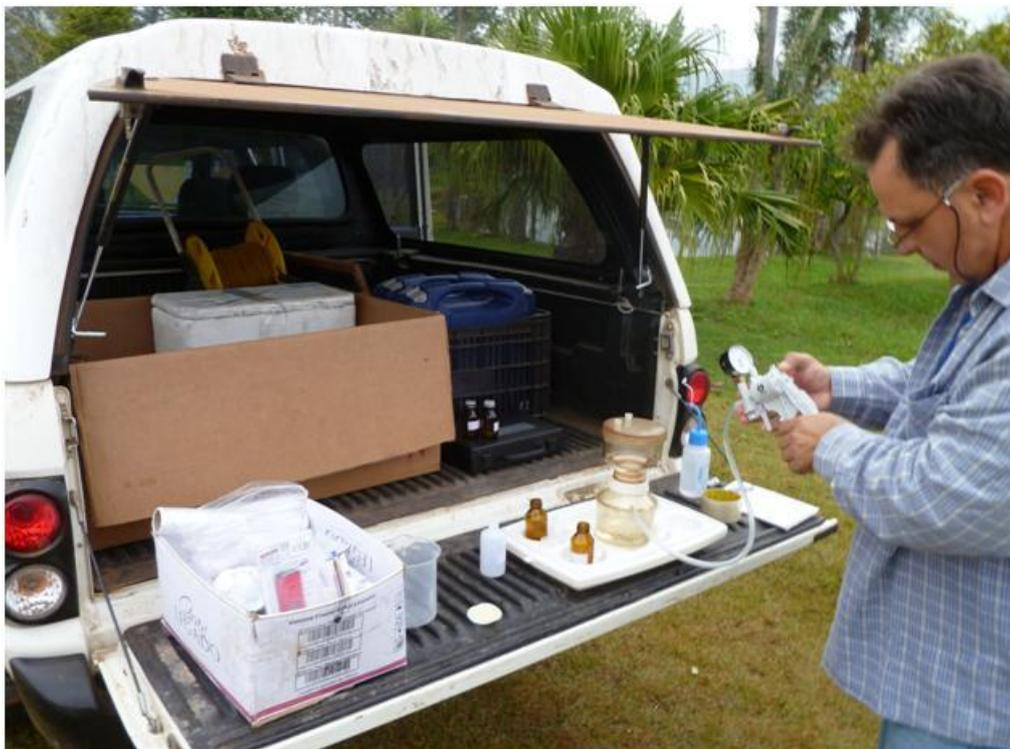
Figura 7. Bomba de vácuo manual e conjunto com filtro de membrana de acetato de celulose 0,45  $\mu\text{m}$  para águas destinadas a análises de cátions e metais dissolvidos
