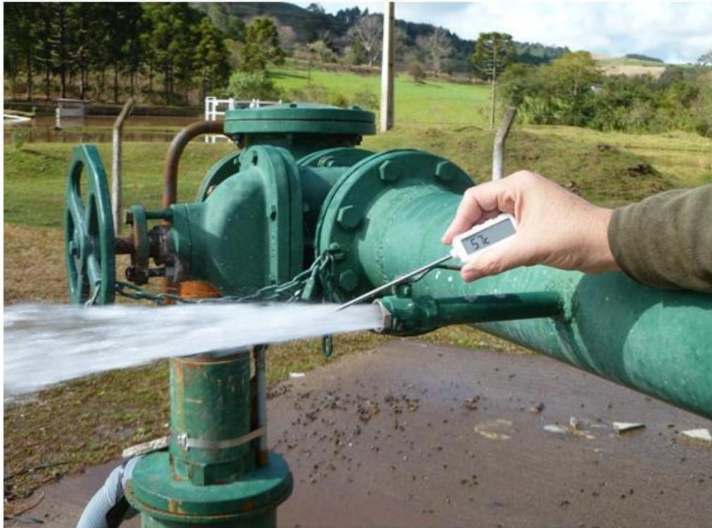
Figura 6. Medição de temperatura da água (57° C) no poço JP-714 que capta o SAG na Linha São Luís São Lourenço do Oeste, SC.
