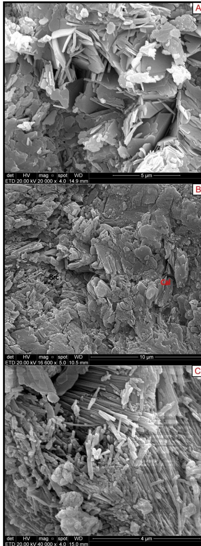
Figura 15 - Imagens obtidas por MEV da pedra Partecal. A) Brucita; B) Brucita e calcita; C) Talco.
