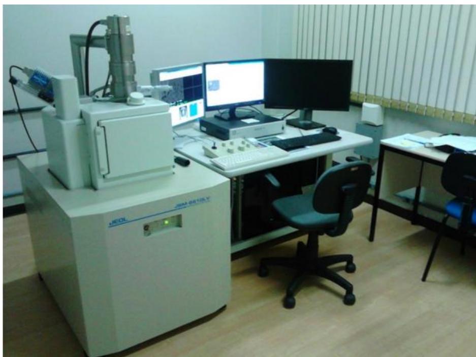
**Figura 10.** Microscópio eletrônico de varredura (MEV) modelo JEOL JSM-6610LV acoplado ao sistema EDS, do Laboratório de Geologia isotópica - UFRGS.
