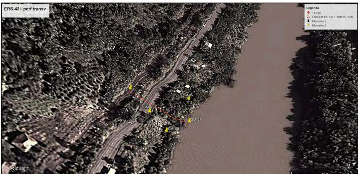
**Figura 16.** Perfil transversal ao eixo da ERS-431, no quilômetro 13+500, no estágio pré-ruptura. O modelo topográfico deste perfil serviu como base para estimar o perfil transversal ao qual foi submetido ao ensaio de estabilidade de talude. Fonte: Modificado de *Google Earth* (2016).
