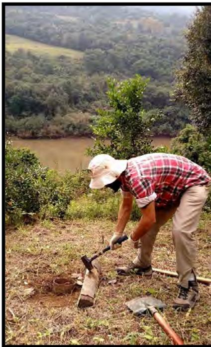
**Figura 8.** Realização do ensaio de densidade de solo coluvionar *In Situ*. Fonte: Dados da Pesquisa.
