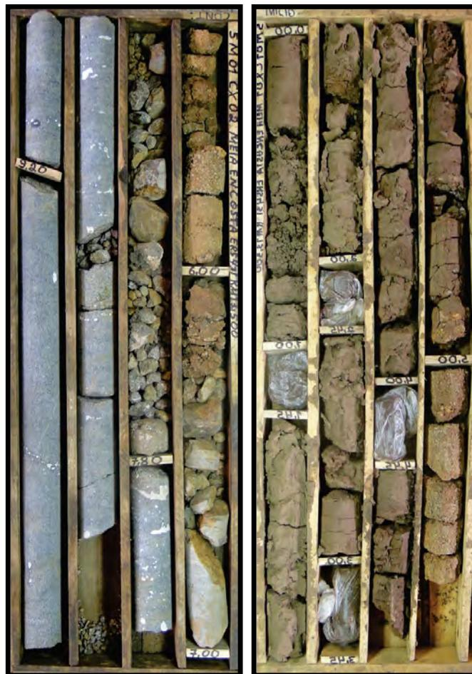
**Figura 6.** Caixas de testemunhos de sondagem mista do furo SM-01, onde a base do furo é composta por basalto maciço são e o seu topo é composto por material coluvionar depositado na região e material proveniente do aterro rodoviário.
