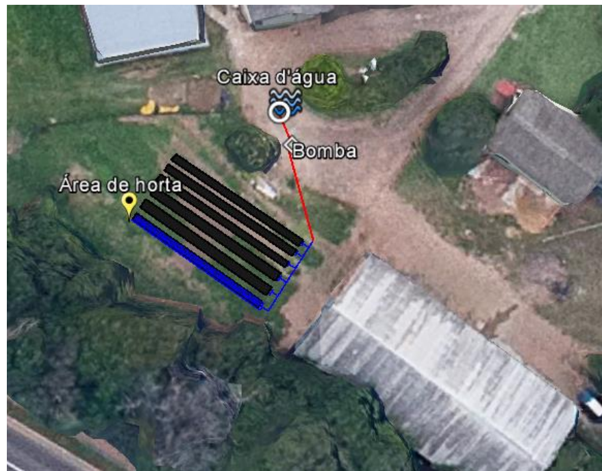
Figura 1- Print screen do software Google Earth para apresentar croqui de sistema de irrigação por gotejamento no campus da Faculdade de Agronomia da Universidade Federal do Rio Grande do Sul.
