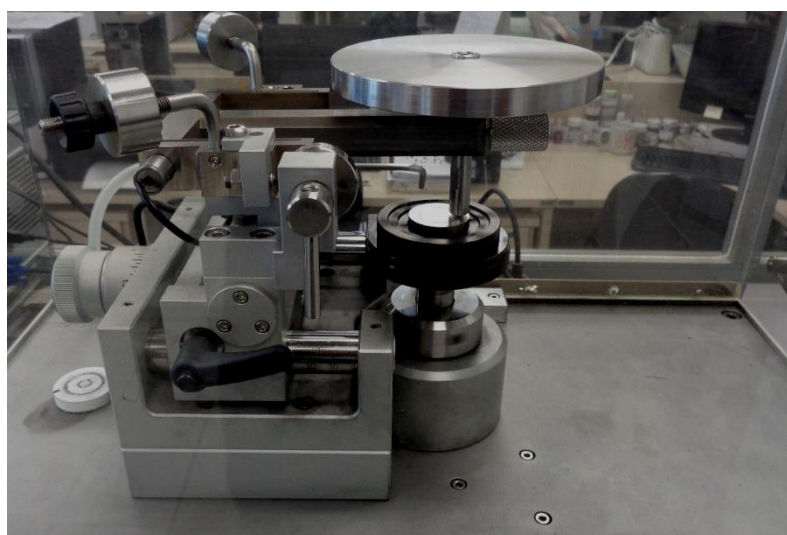
Figura 5.7 Detalhe da célula de ensaio de desgaste com aplicação da carga no corpo de prova através do Pino de ensaio com a esfera de alumina.
