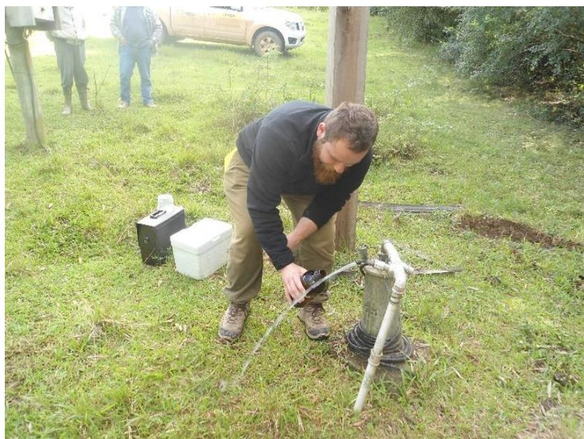
Figura 14: Amostragem de água nos poços tubulares profundos.
