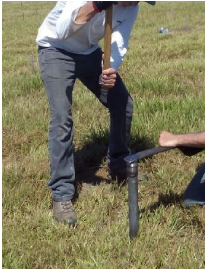
Figura 3. Trado tipo sonda, usado para análises das parcelas de Paspalum notatum acesso TB 42.
