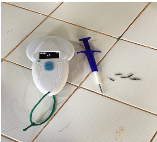
Figura 1 – Sistema de identificação dos peixes: chips , agulha de introdução e leitor
