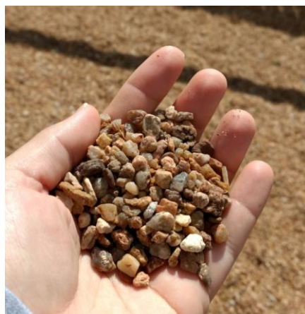
Figura 9: Cascalho tipo ervilha, utilizado em camada de 10cm absorve o impacto de 3,6m.
