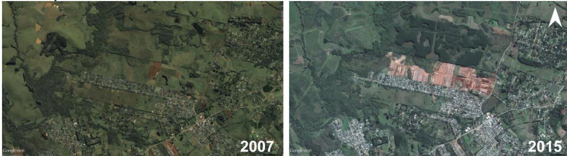
Fonte: Google Earth. A gleba tem, como limite oeste, o arroio Demétrio e sua extensa várzea. Após a terraplanagem da gleba, a água da chuva carrou sedimentos do solo exposto para dentro do arroio Demétrio, provocando o assoreamento da calha do curso d'água. É um empreendimento faixa 1, com 1.180 lotes de unidades habitacionais, localizado no limite da zona urbana.
