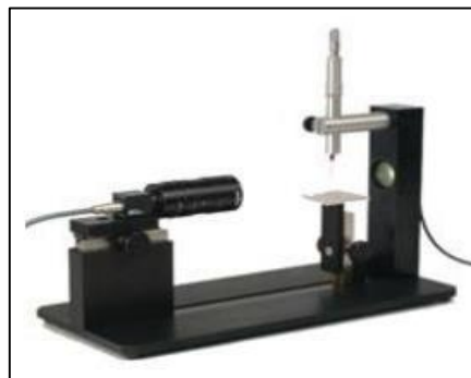
Figura 16: Aparelho utilizado para medida do ângulo de contato (44).
