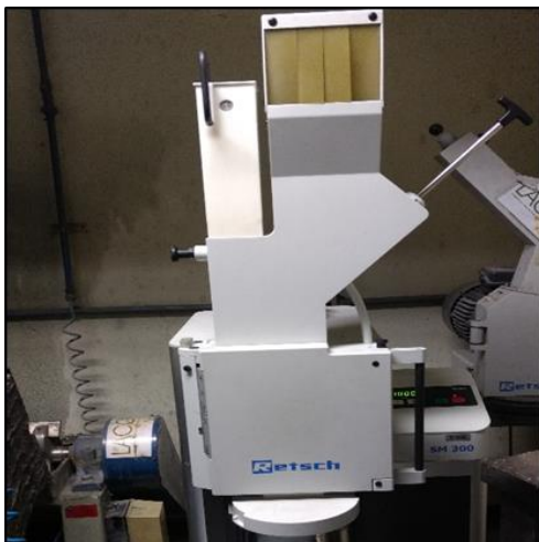
Figura 12: Moinho de facas utilizado na granulação das amostras e amostra após a granulação.
