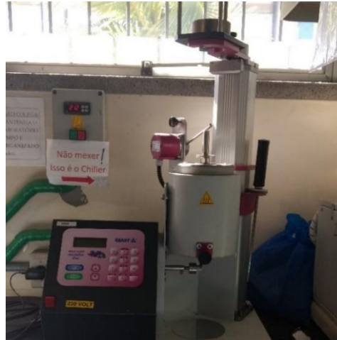
Figura 19: Plastômetro utilizado para o ensaio de MFI.
