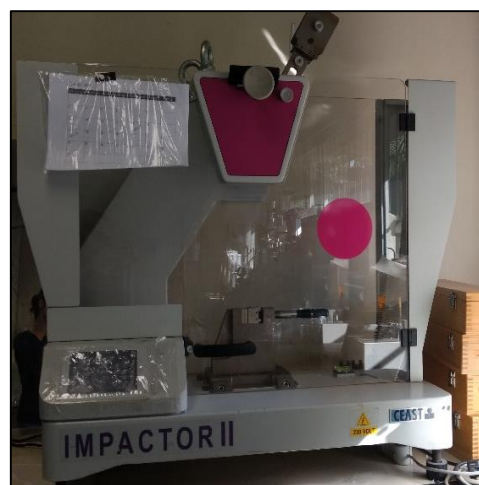
Figura 20: Equipamento utilizado para o ensaio de resistência ao impacto Izod.
