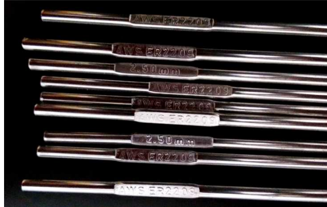
Figura 3. 1. Vareta consumível como recebida. Diâmetro 2 mm
