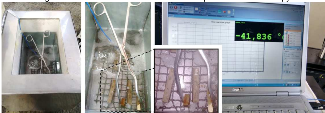
Figura 3. 17. Caixa térmica contendo os CPs para os ensaios Charpy
