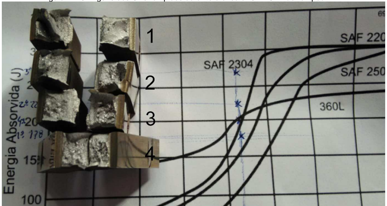
Figura 4. 18. Alguns dos CPs rompidos durante o ensaio. O 4º CP não rompeu.
